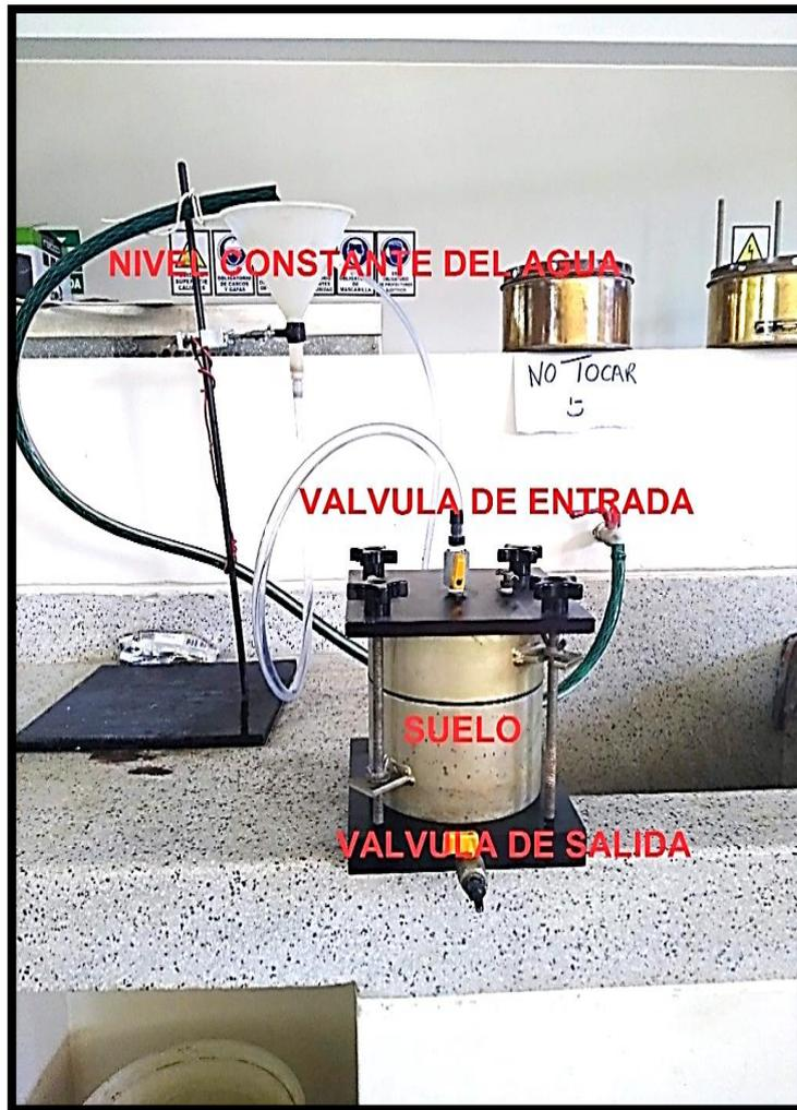
Figura 5. Permeámetro utilizado en ensayo
