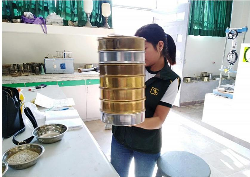
Figura 7. Procedimiento del análisis granulométrico
