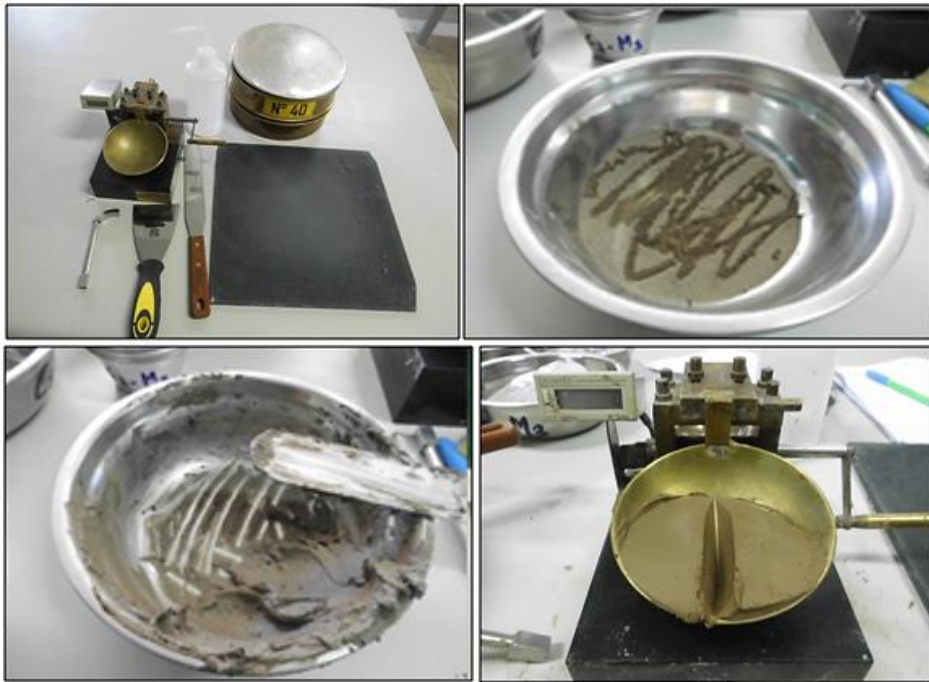
Ilustración 15. Procedimiento de ensayo límite líquido
