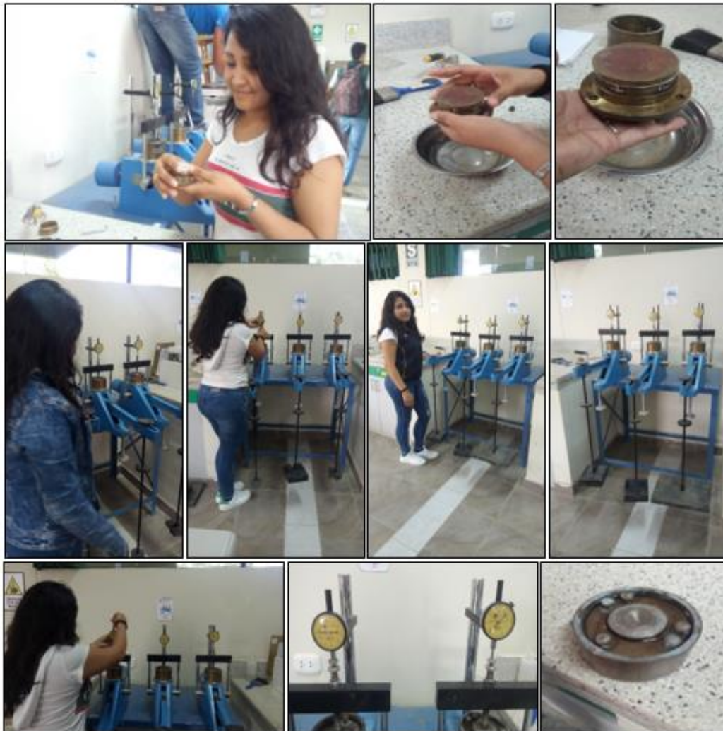
Ilustración 18. Procedimiento ensayo de consolidación unidimensional
