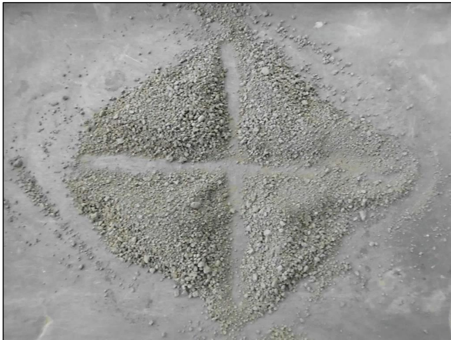
Ilustración 11. Procedimiento de cuarteo para obtener muestra representativa a ensayar
