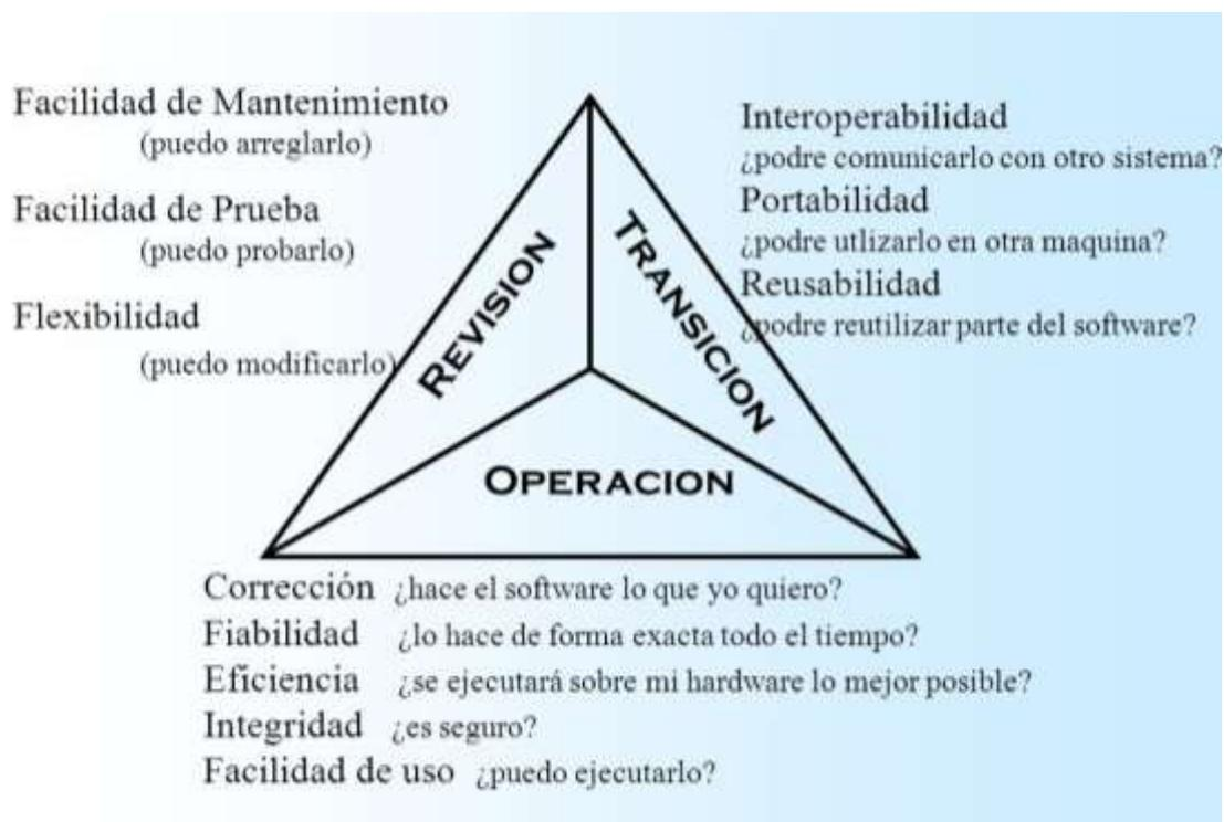
Figura 2. Estructura del modelo McCall. Fuente: (Villareal, 2018)
