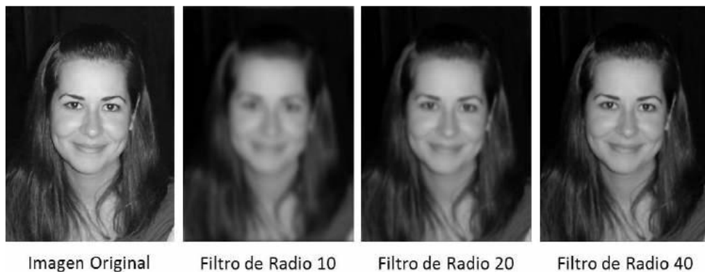
Figura 9. Filtro gaussiano con diferentes radios. Tomado de Las operaciones de la imagen sobre el histograma y filtrado . Fuente: (Aranda, 2016) (Edits.), Métodos y conceptos en visión por computadora , p. 39.
