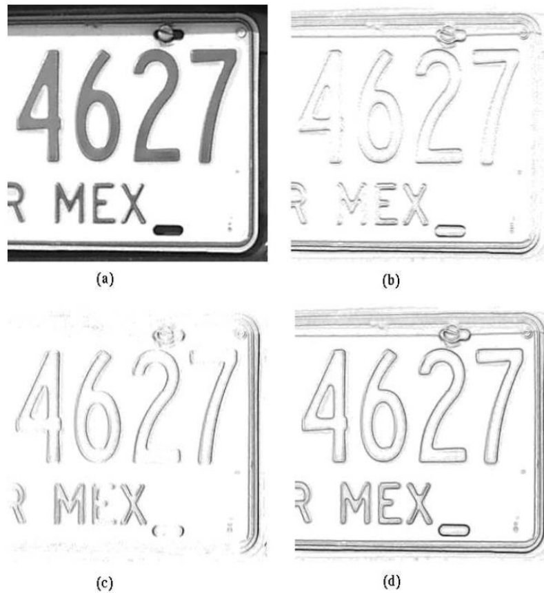
Figura 18: El Sobel de operadores, prestar atención del incluido suavizamiento a los operadores de Prewitt. Fuente: (Sucar, Visión Computacional, 2017)
