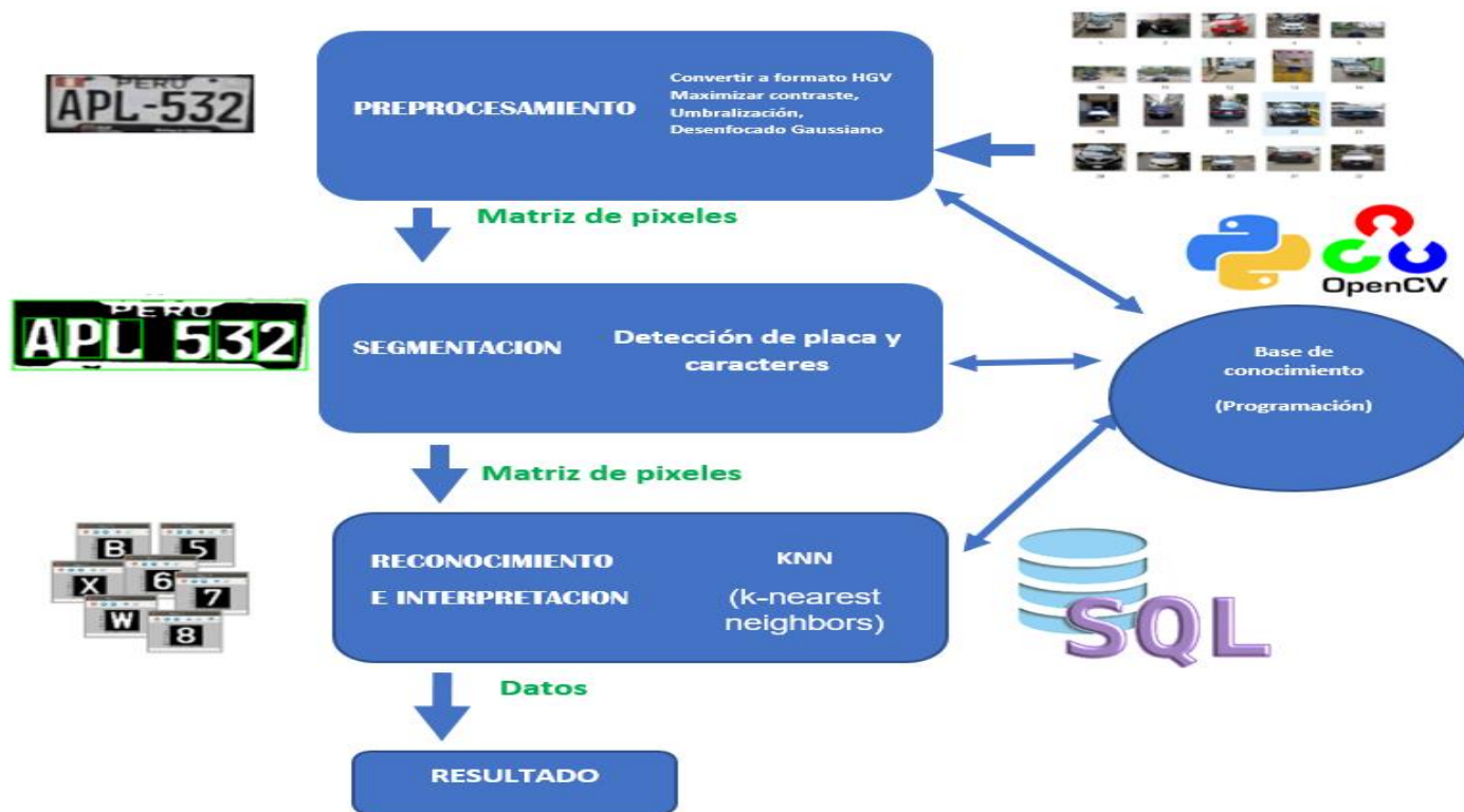
Figura 33: En la presente figura se describir cómo los elementos planteados interactúan y apoyan el algoritmo de visión artificial implementado, la entrada es una imagen capturada, la primera fase es el preprocesamiento donde se condiciona la imagen para el buen funcionamiento del proceso, luego sigue la fase de segmentación donde los caracteres de la matricula son separados, se prosigue a la fase de Reconocimiento Óptico de Caracteres con la finalidad de reconocer y convertir a código alfanumérico los caracteres de la matricula, los mismos que serán contrastados con una BD SQL y determinar si el vehículo tiene acceso permitido al parqueadero.
