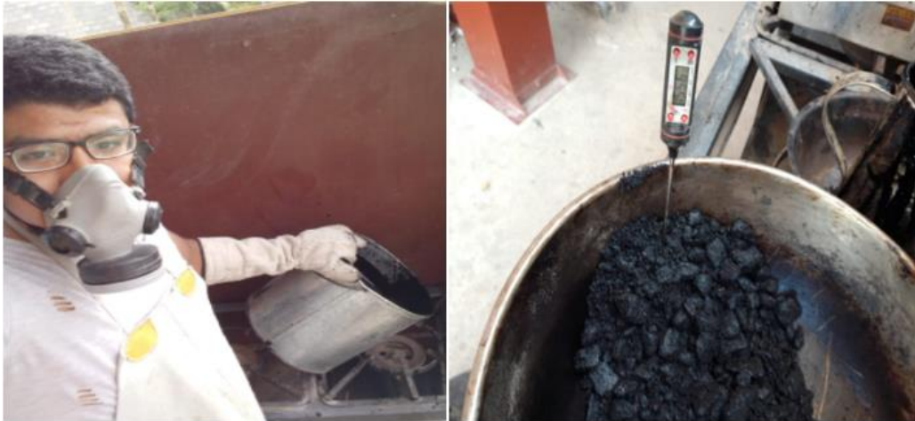
Figura 108. Elaboración de la mezcla asfáltica
