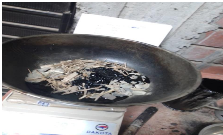
Figura 3. Combinación de agregados pétreos, filler, FBC y C.A Pen 60/70 (mezcla asfáltica en caliente).
