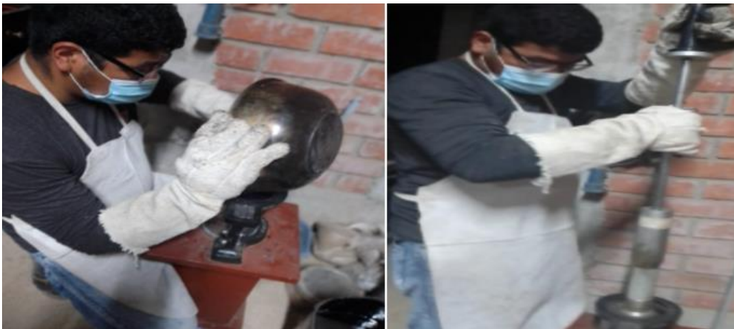
Figura 109. Vaciado y compactación con el martillo Marshall.
