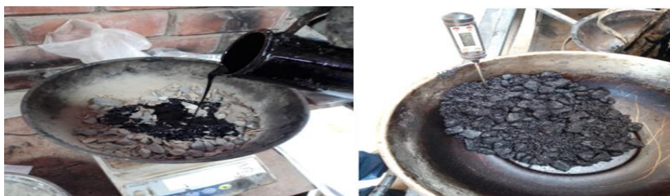
Figura 11. Elaboración de la mezcla asfáltica.
