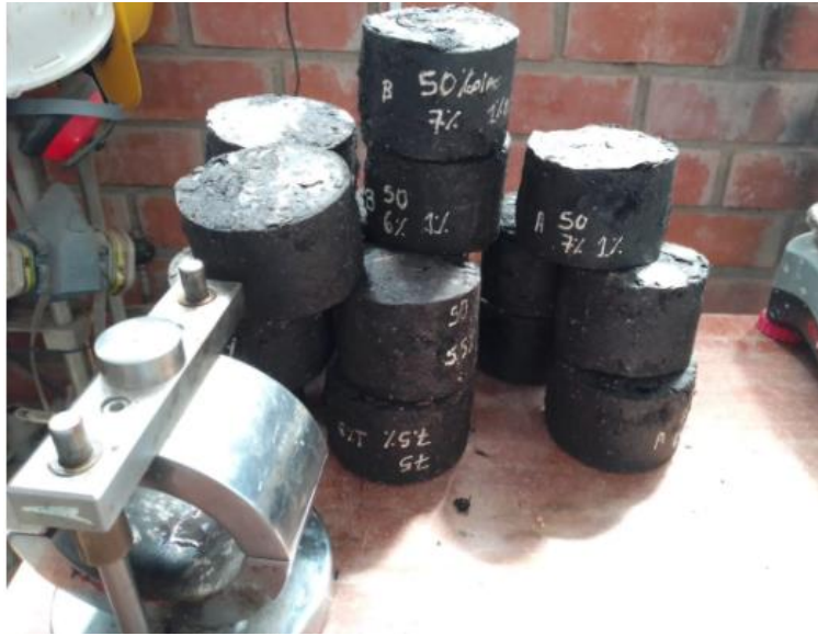
Figura 111. Briquetas asfálticas después del ensayo Marshall
