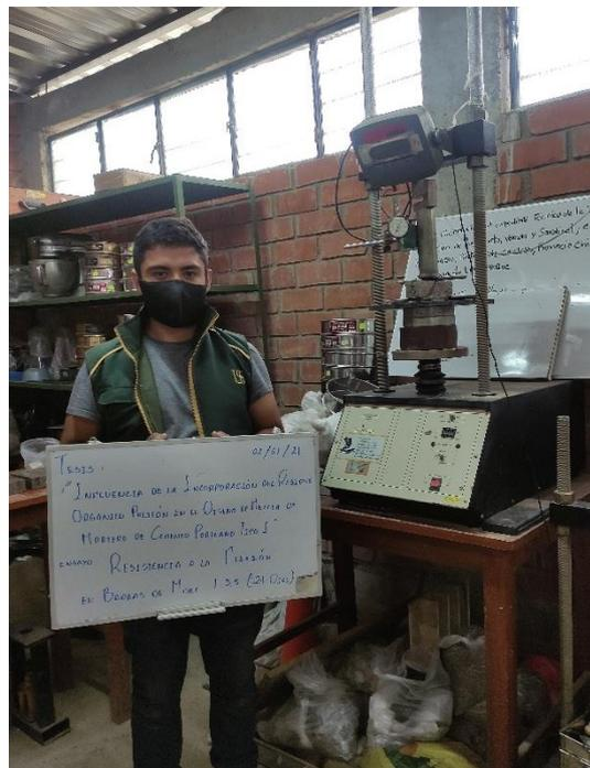
Figura 52. Ensayo de Resistencia a la Flexión en Vigas de Mortero.
