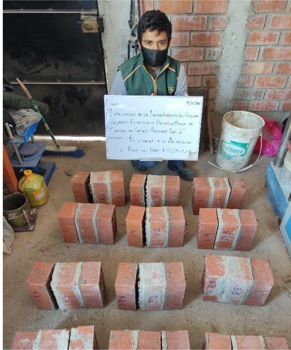
Figura 53. Ensayo de Adherencia en Pilas con Mortero Patrón.
