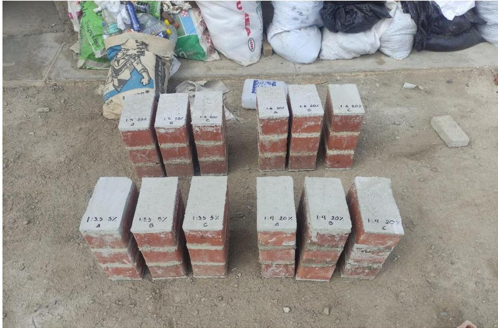
Figura 59. Refrentado de Pilas para ensayo de Compresión Axial.
