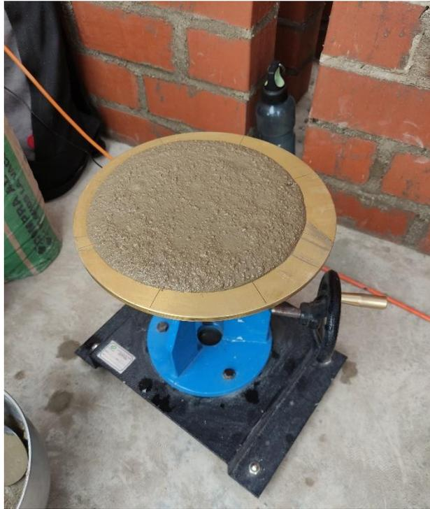
*Figura 41. Ensayo de Fluidez en Mezcla Preliminar*
