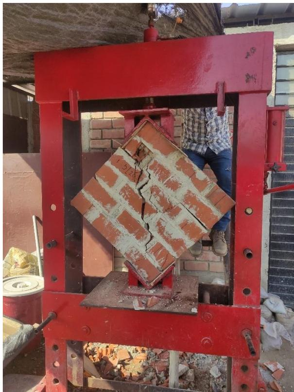
*Figura 58.* Falla Diagonal en Murete Elaborado con Mortero Experimental.
