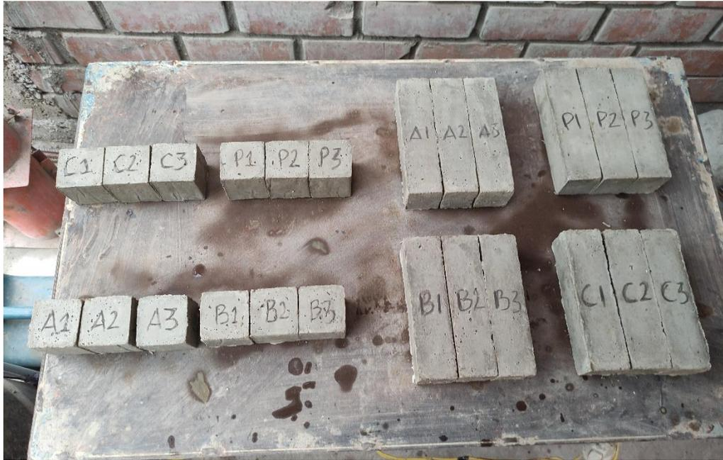
Figura 43. Desmoldado de Muestras Preliminares de Mortero
