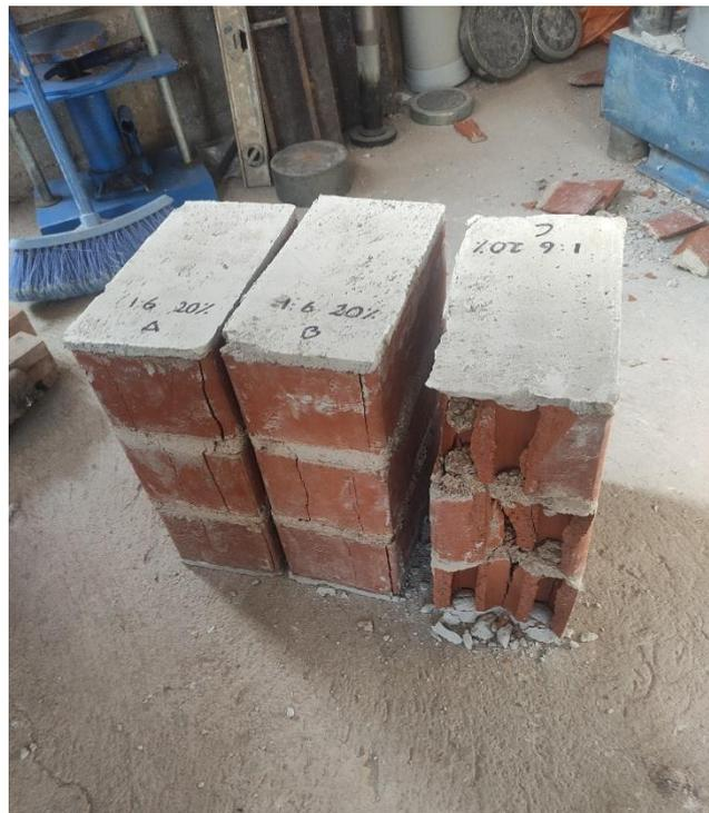
Figura 60. Falla de Pilas de Albañilería por Compresión Axial.
