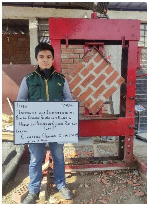
Figura 56. Ensayo de Compresión Diagonal en Muretes para Mortero Experimental.
