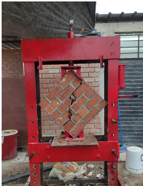
*Figura 48. Falla diagonal escalonada en Muretes con Mortero Patrón*
