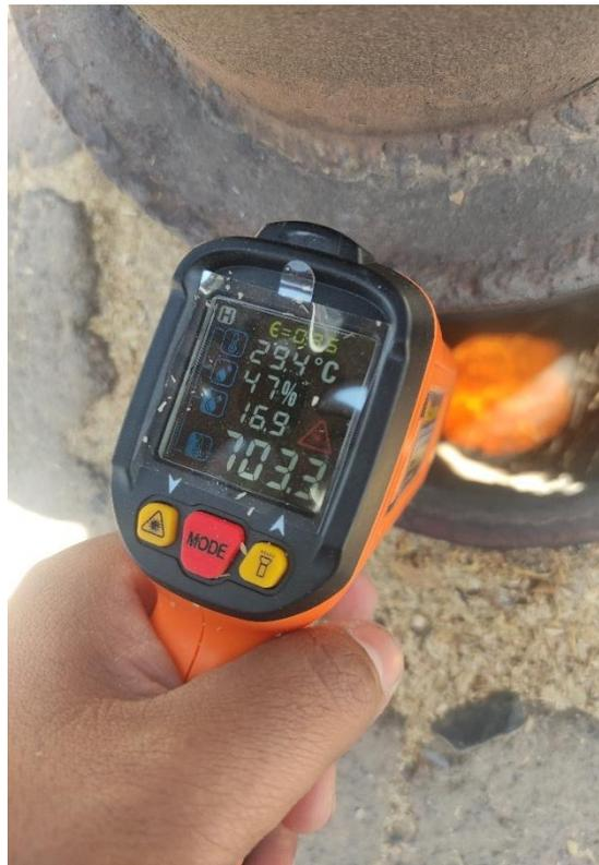
Figura 66. Toma de Temperatura en Horno.
