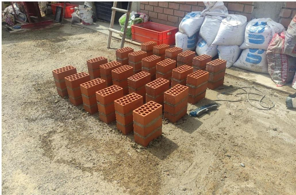
Figura 54. Elaboración de Pilas de Albañilería con Mortero Experimental.
