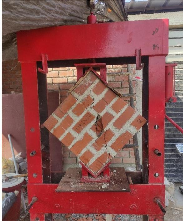
*Figura 57.* Falla Diagonal en Murete Elaborado con Mortero Experimental.
