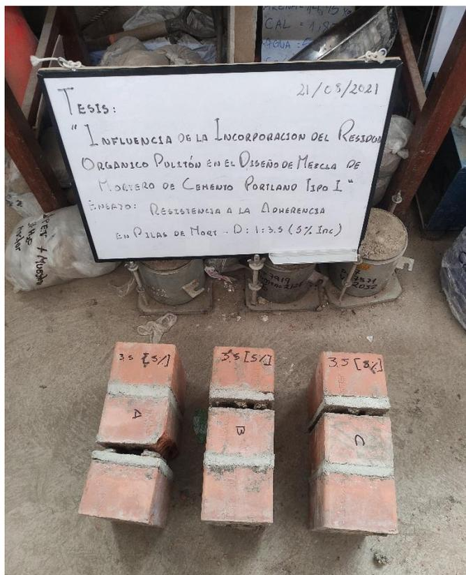
Figura 55. Ensayo de Resistencia a la Adherencia en Mortero Experimental.
