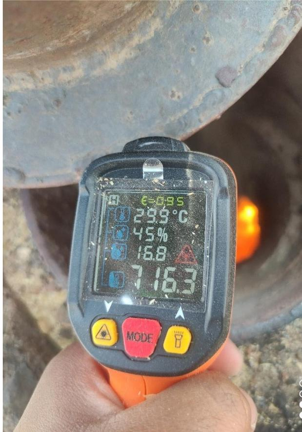
Figura 67. Toma de Temperatura en Horno.
