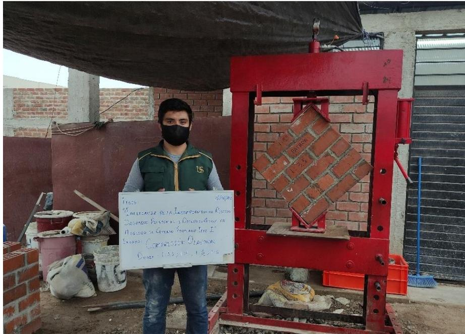
*Figura 47. Ensayo de Resistencia a la Compresión Diagonal en Muretes elaborados con Mortero Patrón*
