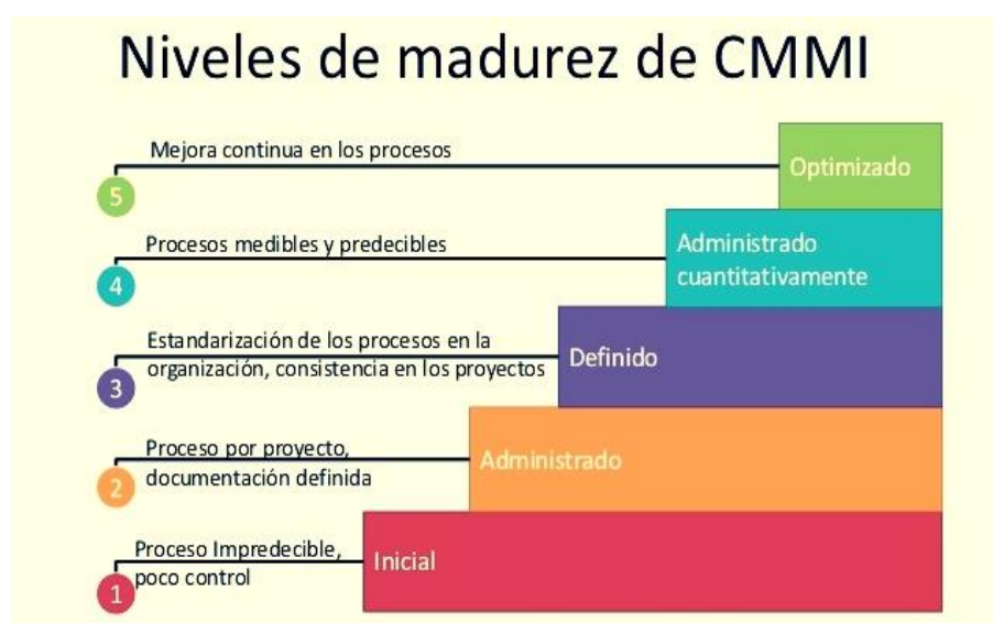
Figura 4. Modelos de Madurez de CMMI (Integración de sistemas modelos de madurez de capacidades). Fuente: (Orta & Ruiz , 2018)
