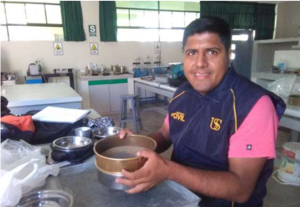
Figura 9: Obteniendo material después de pasar por el tamiz N° 40, para el ensayo de Límite Líquido y Plástico.
