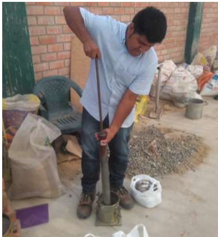
Figura 14: Realizando golpes por cada capa. Ensayo de Proctor.
