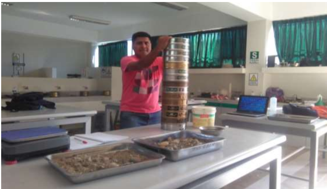
Figura 12: Realizando el ensayo de Análisis Granulométrico.
