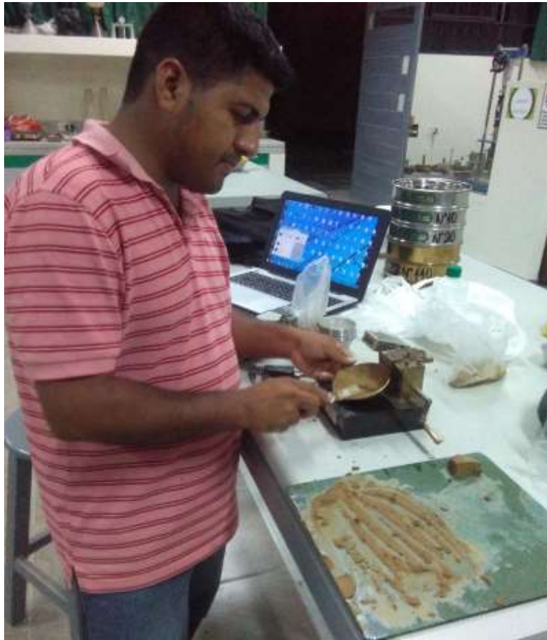
Figura 11: Copa de Casagrande, ensayo Límite Líquido.
