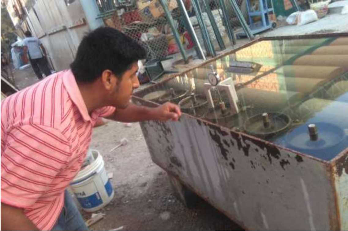
Figura 15: Tomando apunte de la expansión de las muestras. Ensayo de CBR.
