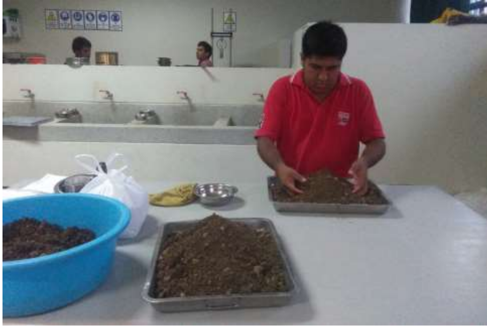
Figura 13: Mezclando el material con la proporción de agua determinada. Ensayo de Proctor.
