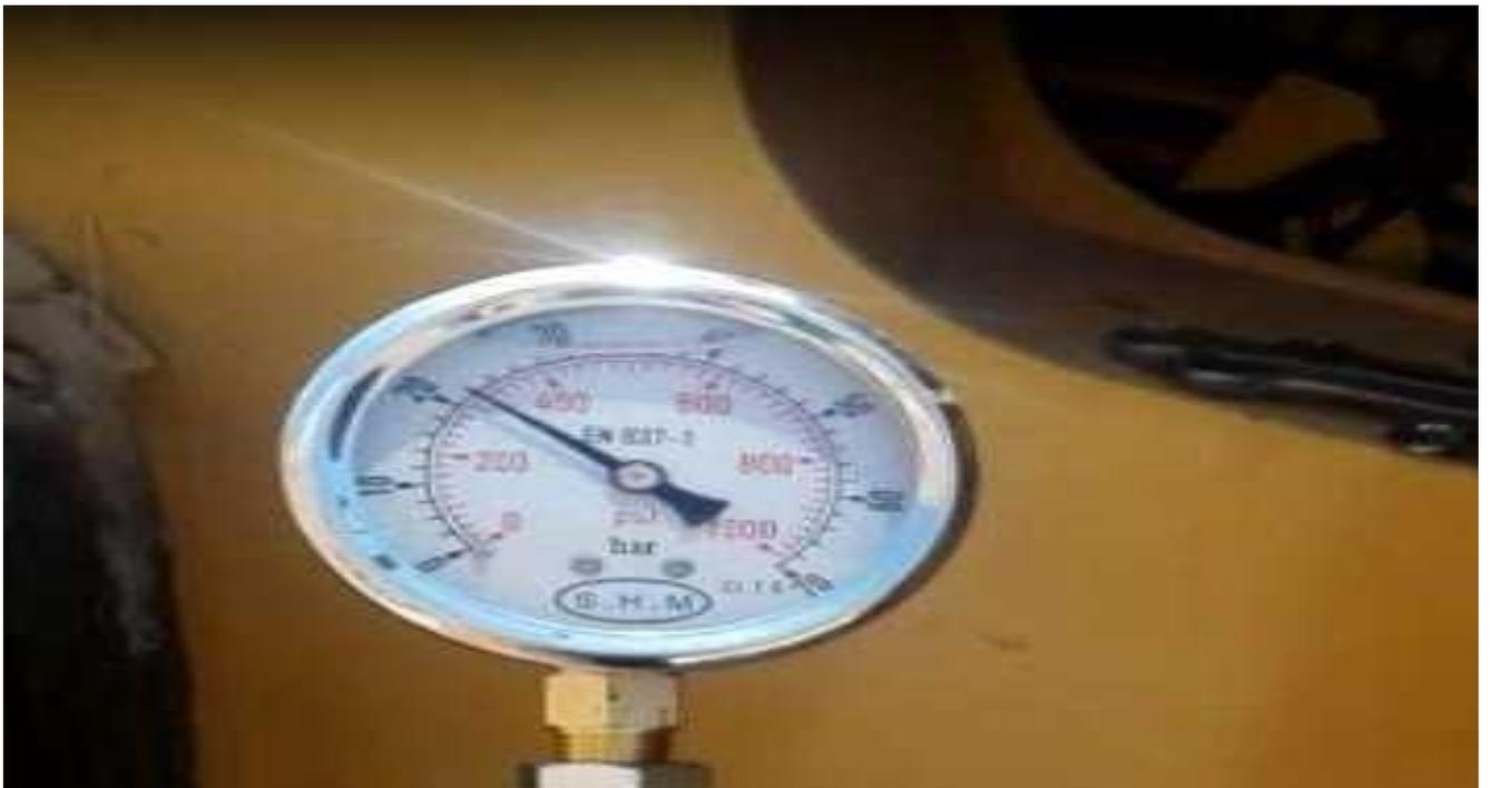
Figura 15 *Medición de Presión con Nanómetro para la caja de cambio*
