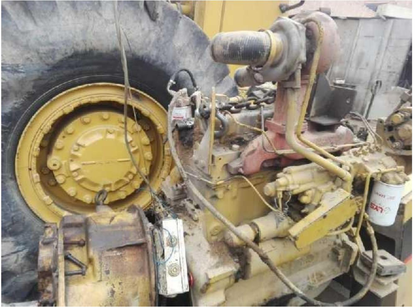
Figura 47 Proceso De Mantenimiento Correctivo A Los Componentes De La Caja Powershift
