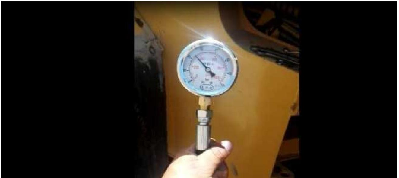
Figura 17 Medición de Presión para la Caja de Cambios.
