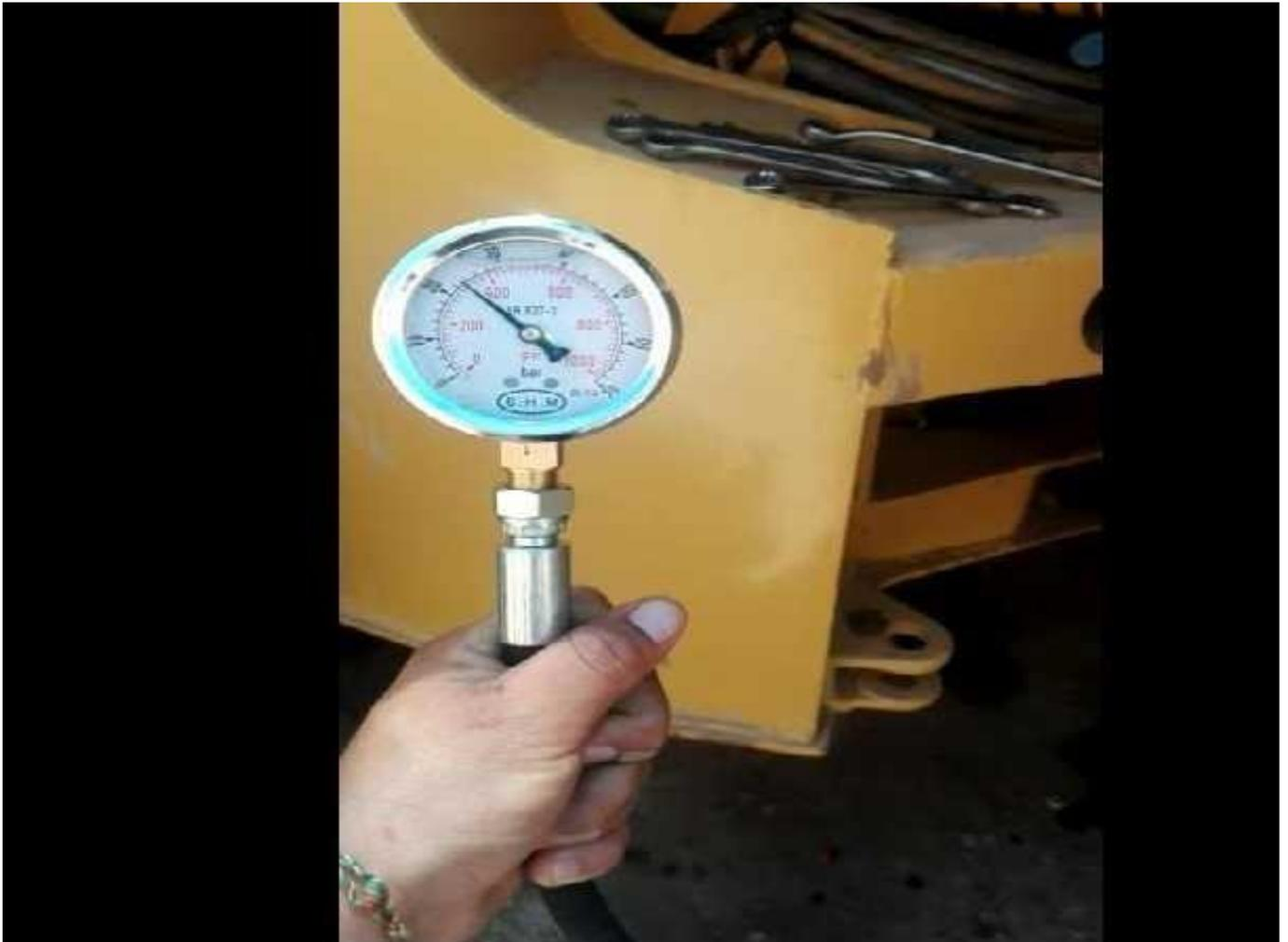
Figura 13 : *medición de presión con manómetros en un cambio de la caja.*
