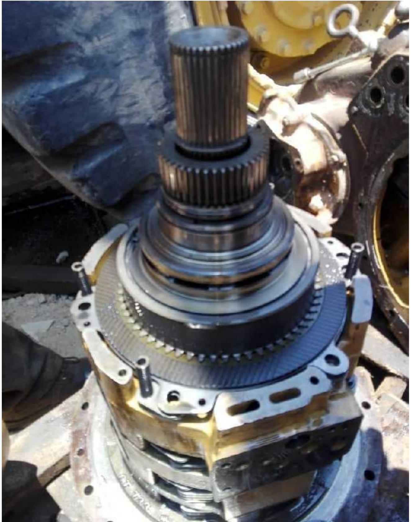
Figura 46 Proceso De Mantenimiento Correctivo A Los Componentes De La Caja
