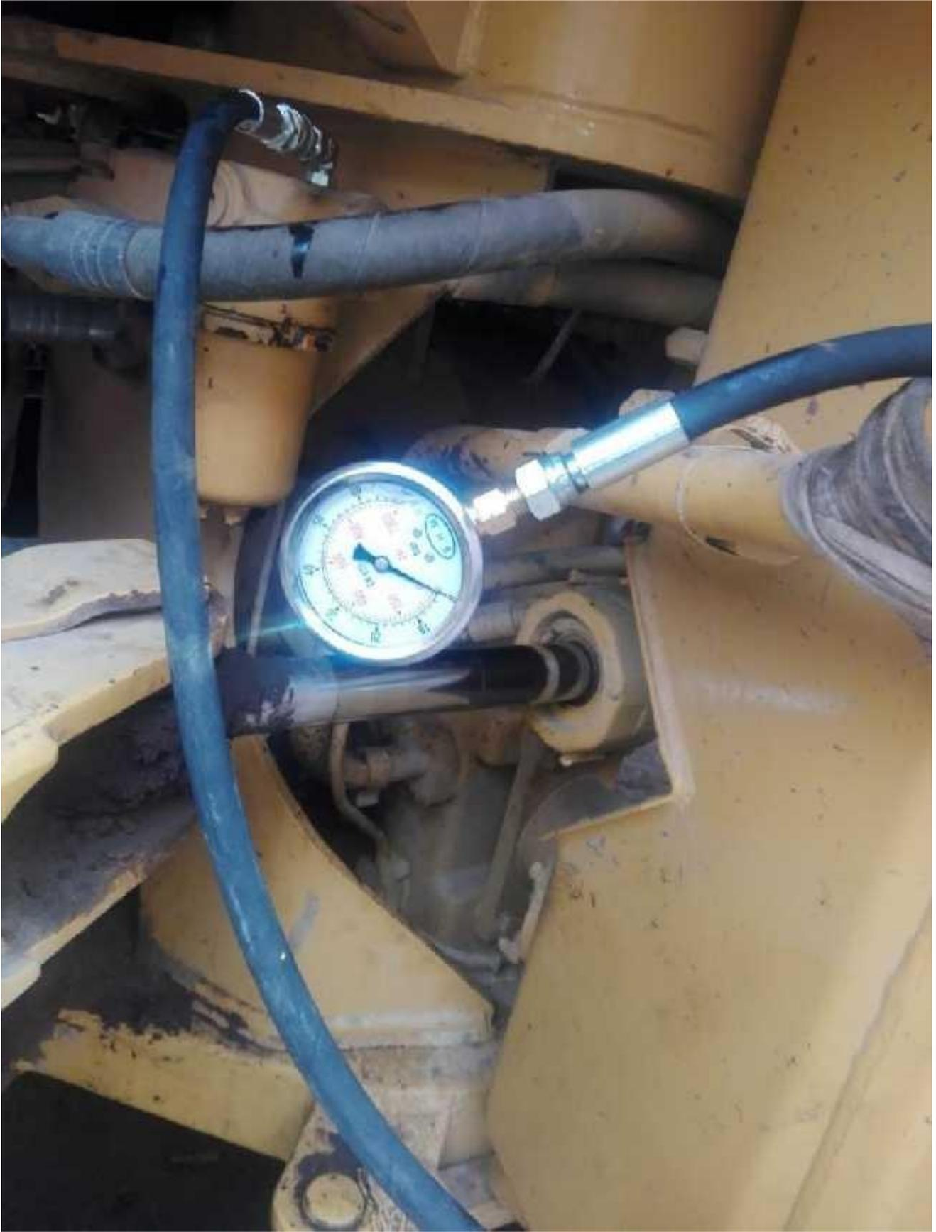
Figura 45 Imagen Del Proceso De Medición De Presión De La Caja Powershift
