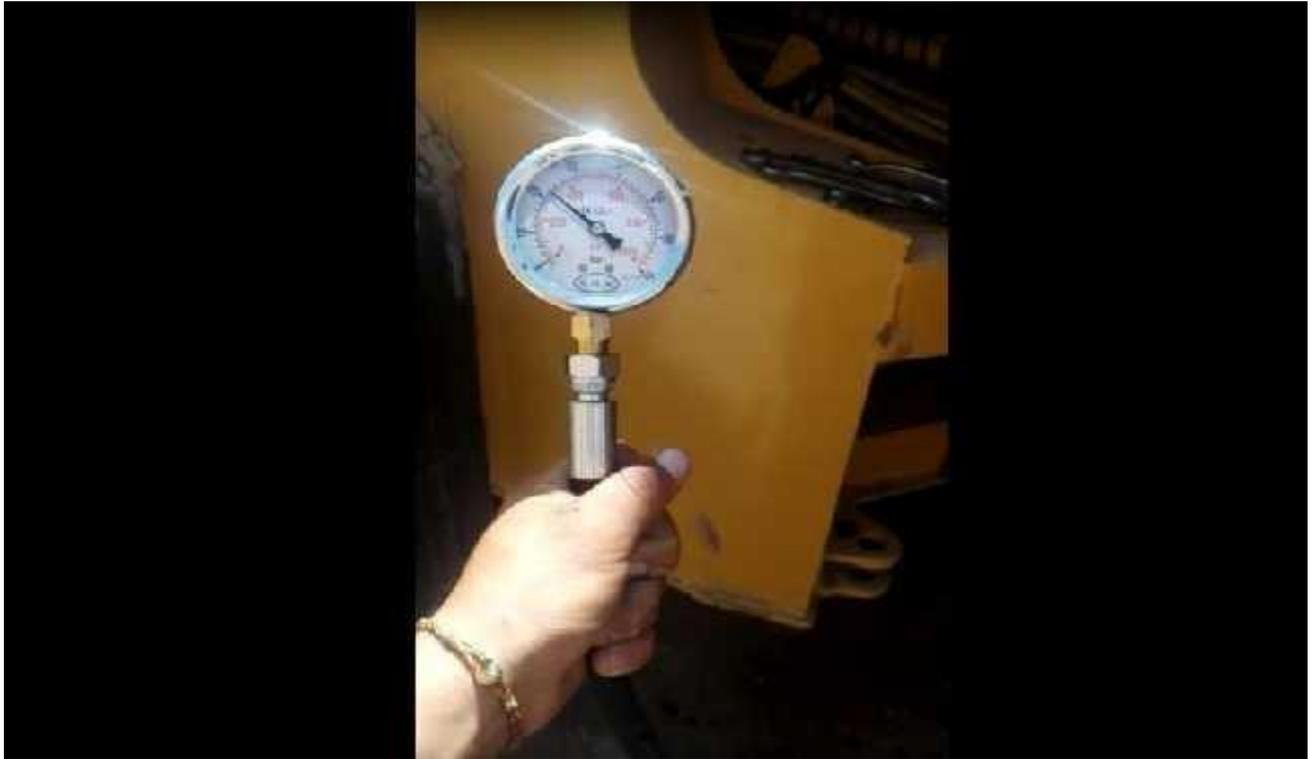
Figura 14 *Medición de Presión en caja de cambios.*
