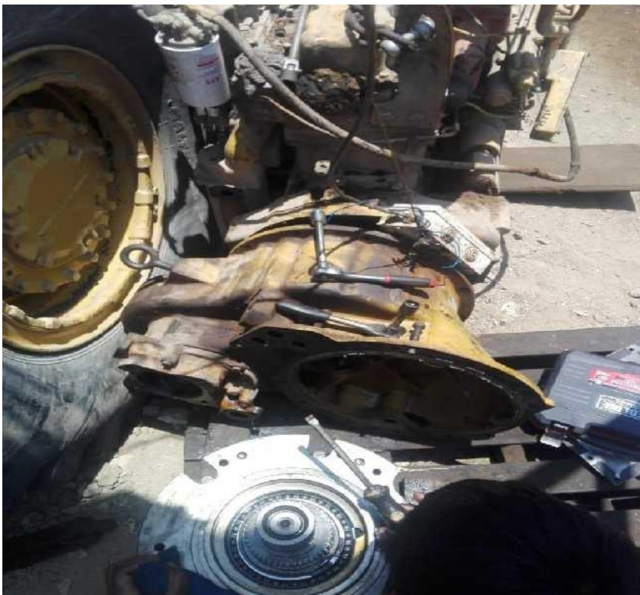
Figura 33 DESMONTAJE DE CAJA CILINDRICA
