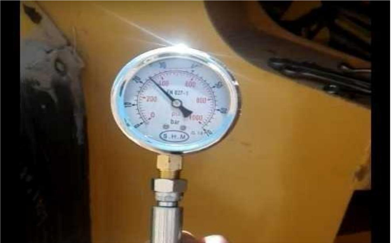
Figura 16 Medición de Presión con manómetro en la caja de cambio.
