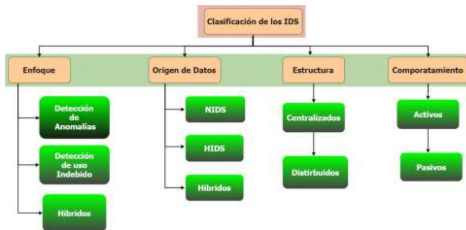
Figura. 2. Clasificación de los IDS - Estado del Arte Sistemas De Detección De Intrusos. Fuente: (Tejada, 2015).
