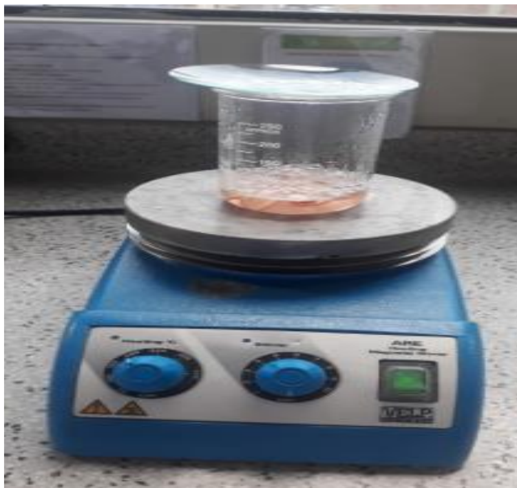
Figura 4: Extracción de Nitratos de 0,5 g de muestra Fuente: Elaboración propia
