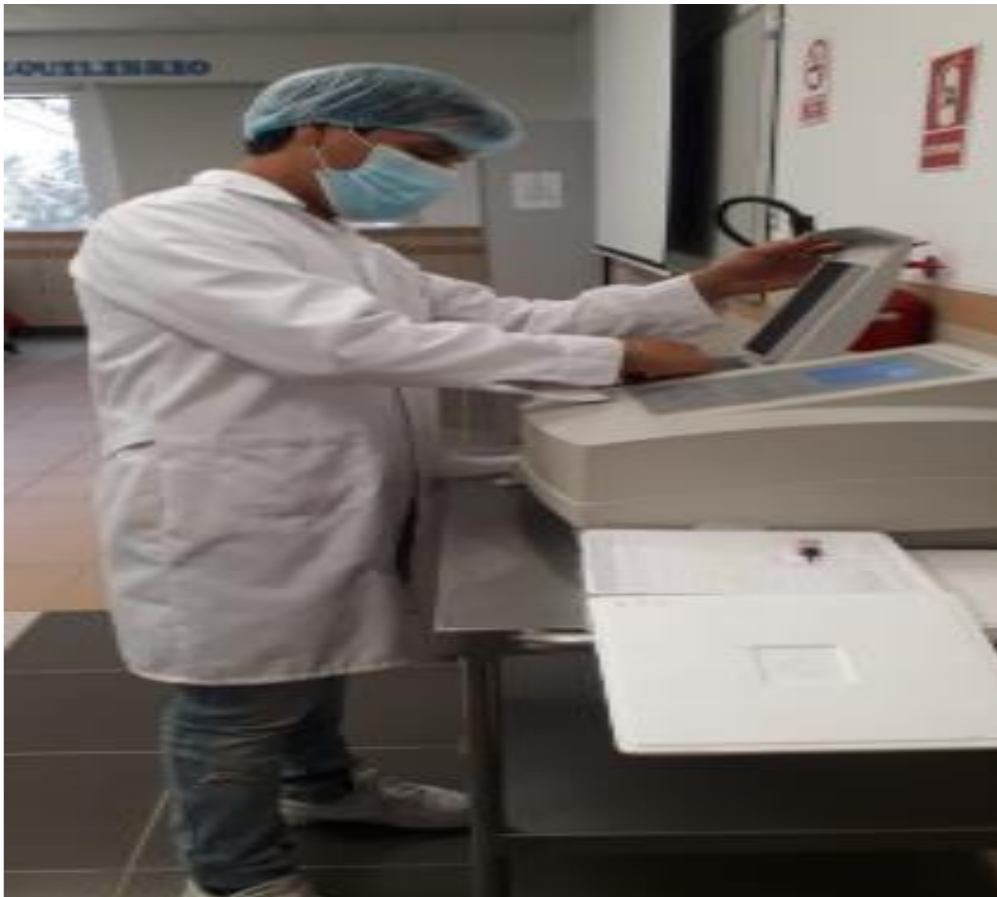
Figura 6: Evaluación de Absorbancias por espectrofotometría Fuente: Elaboración propia
