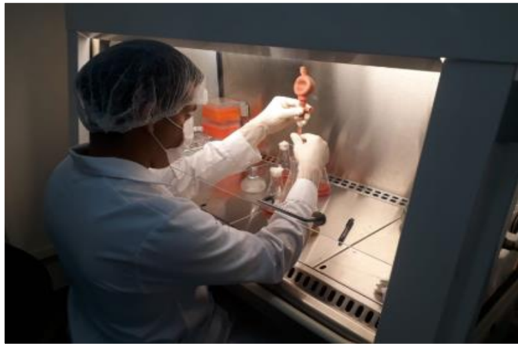
Figura 11: Adición de Agua 90 ml de agua peptonada en 10 g de carne. Fuente: Elaboración propia
