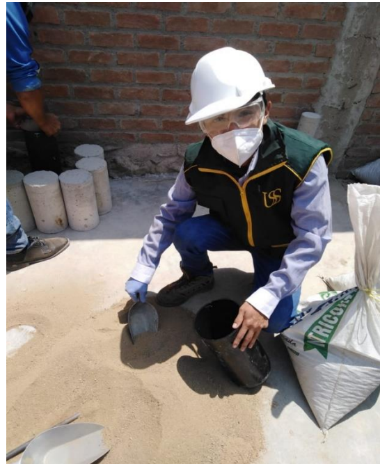
Figura 28: Peso unitario suelto y compactado del agregado fino
