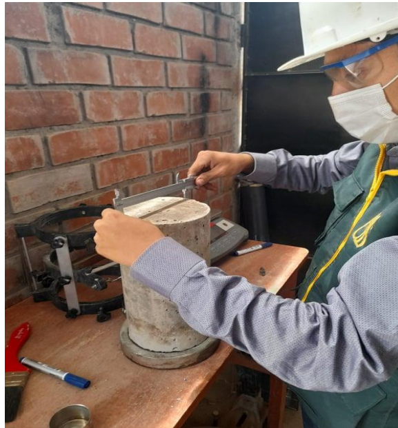
Figura 35: Medida del diámetro de probeta de concreto
