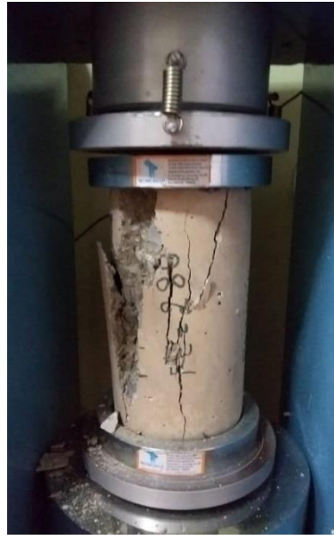
Figura 37: Resultado del ensayo de resistencia a compresión
