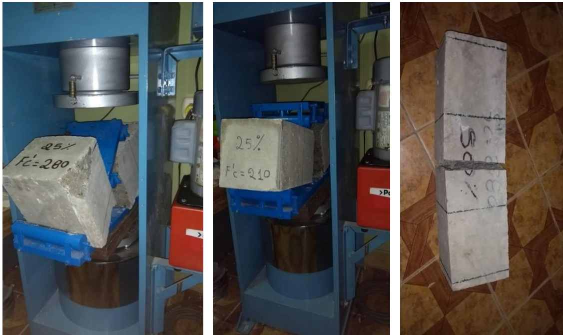
Figura 39: Ensayo de resistencia a flexión
