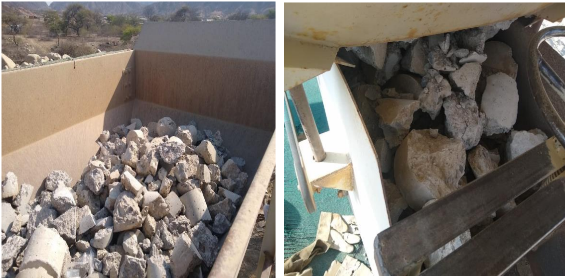
Figura 25:Proceso de triturado del agregado reciclado
