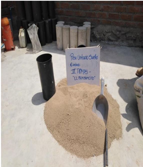
Figura 28: Peso unitario suelto y compactado del agregado fino
