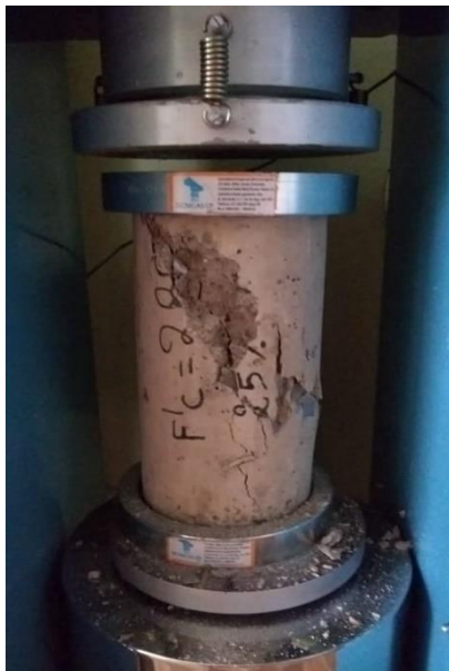
Figura 37: Resultado del ensayo de resistencia a compresión
