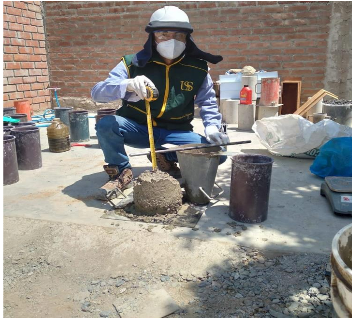
Figura 32: Consistencia del concreto
