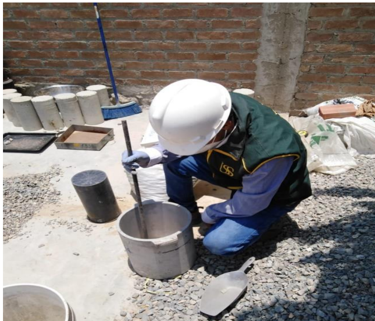
Figura 29: Peso unitario suelto y compactado del agregado grueso
