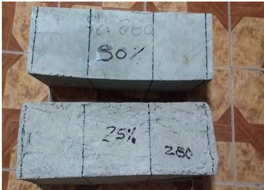
Figura 38: Ensayo de resistencia a la flexión (marcado las zonas de ensayo)
