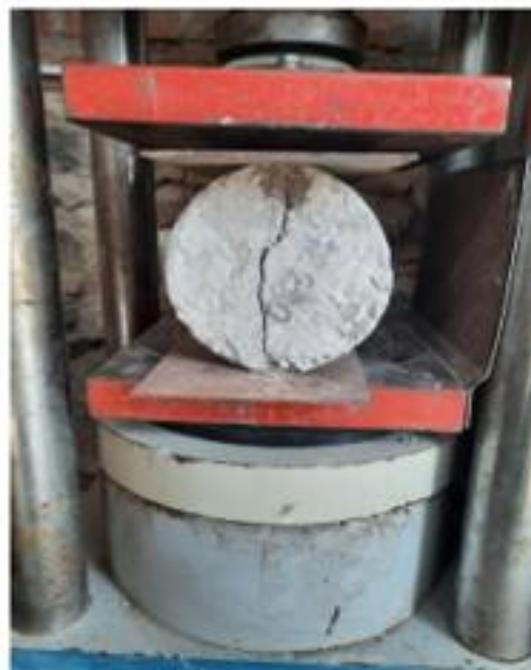
*Figura 48.* Ensayo de resistencia a tracción
