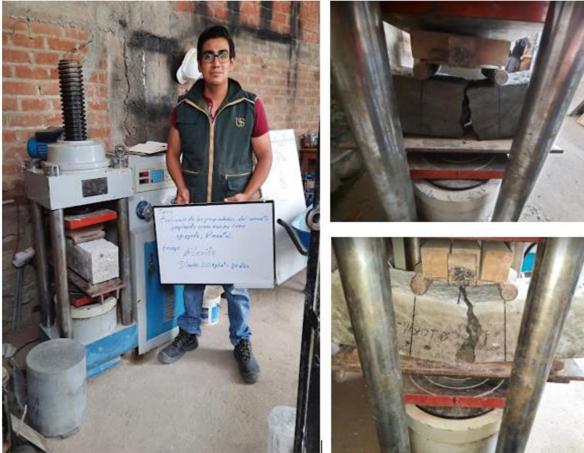
**Figura 49.** Ensayo de resistencia a tracción
