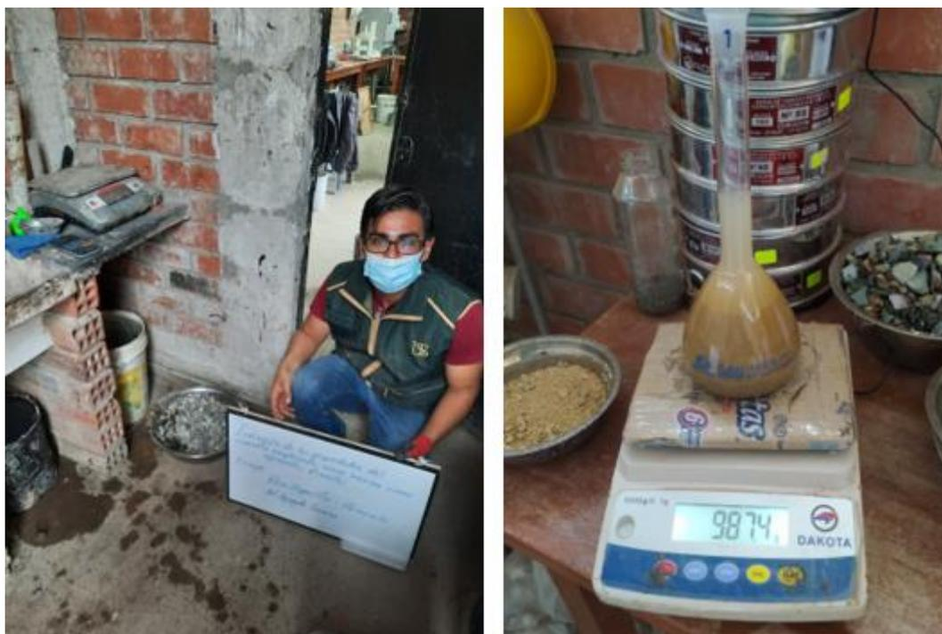
**Figura 36.** Ensayo de peso específico y absorción del agregado grueso y fino
