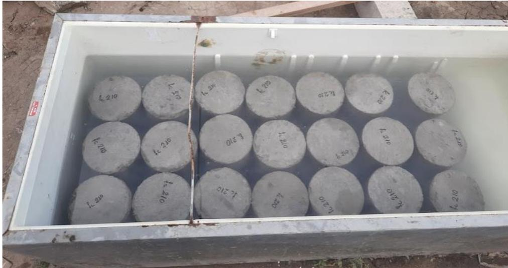
**Figura 44.** Curado de probetas
