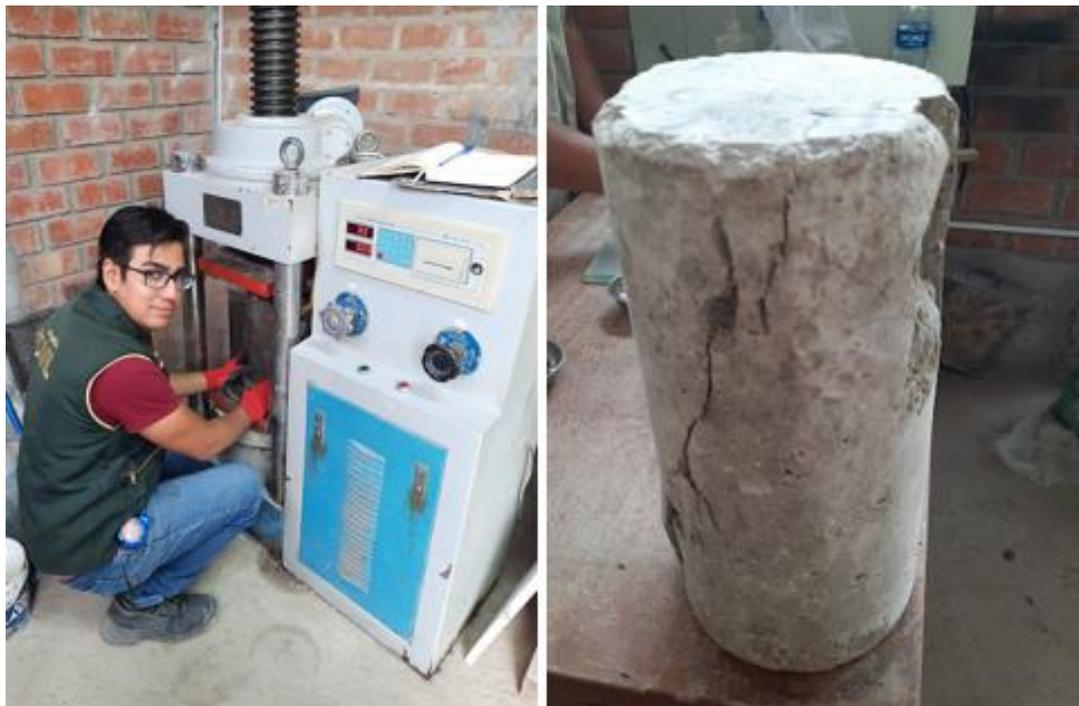
**Figura 47.** Rotura de probeta
