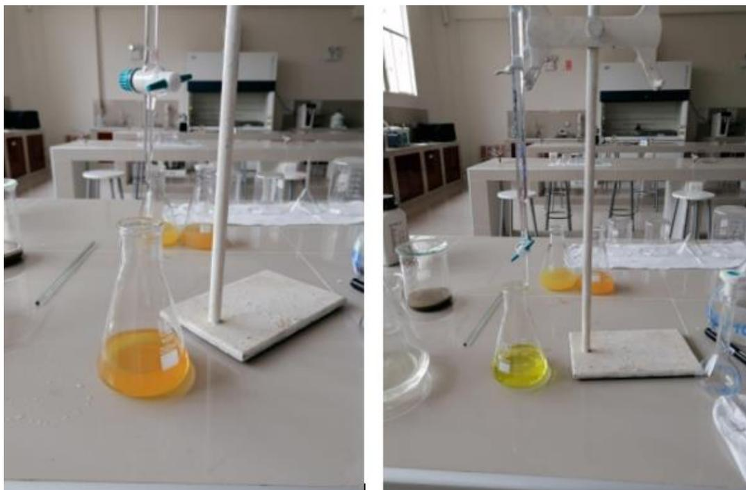
*Figura 54.* Ensayo de cloruros de la arena marina
