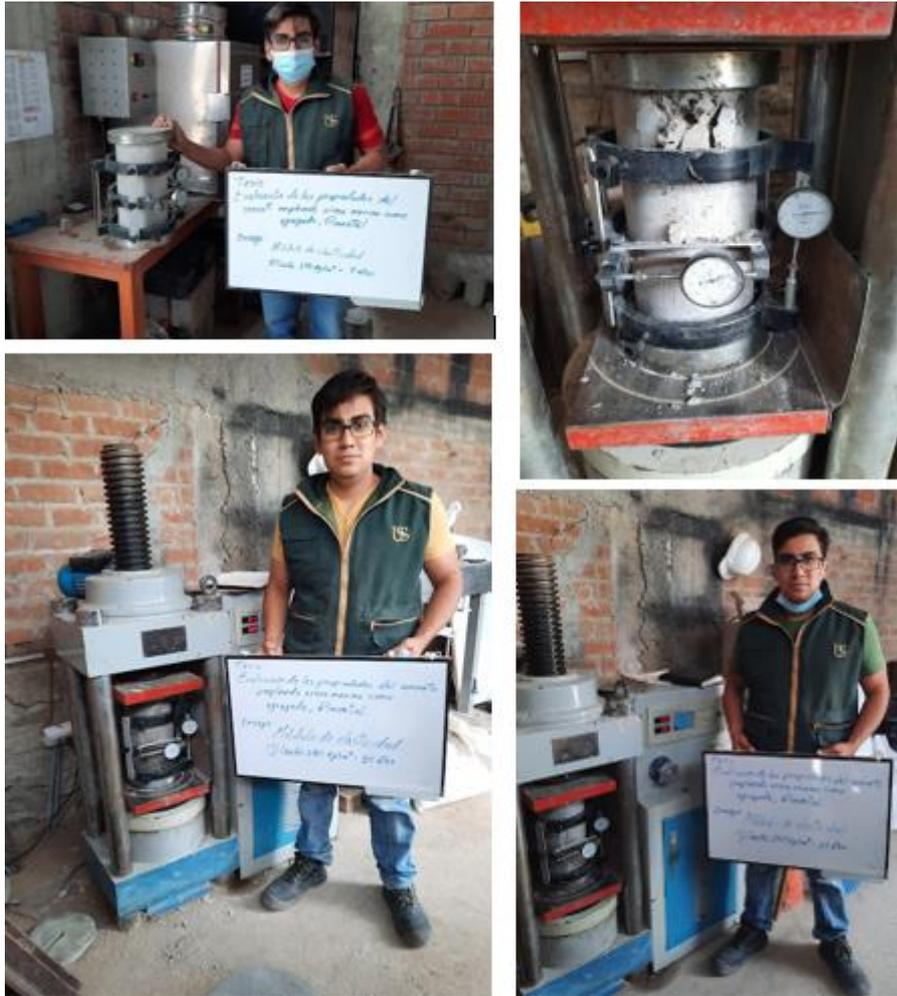
**Figura 50.** Ensayo de módulo de elasticidad
