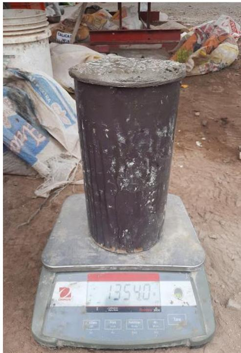
**Figura 41.** Ensayo de peso unitario del concreto
