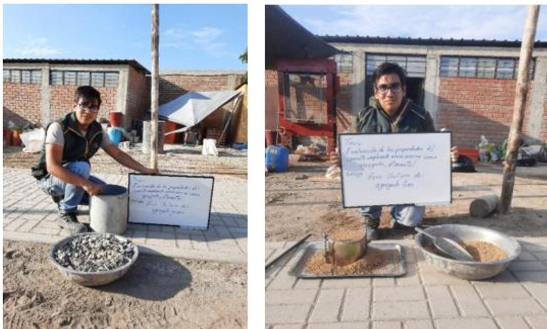
**Figura 35.** Ensayo de peso unitario de agregado grueso y fino
