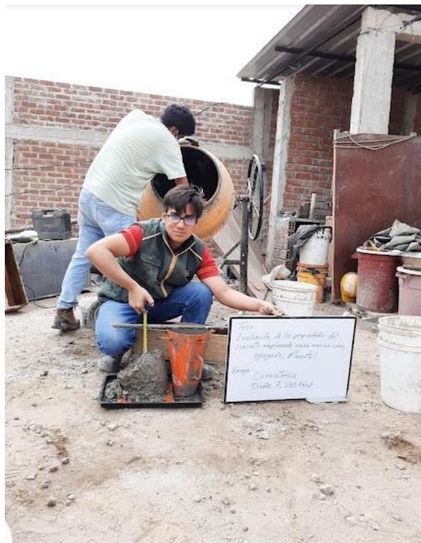
**Figura 39.** Ensayo de consistencia del concreto en su estado fresco
