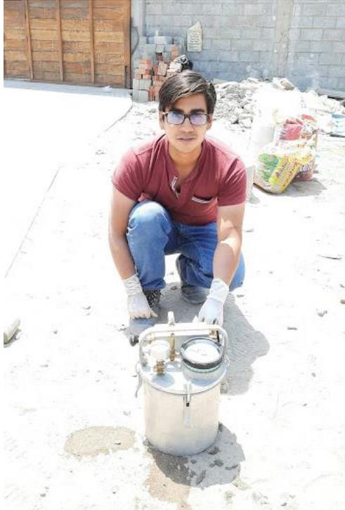
**Figura 42.** Ensayo de contenido de aire del concreto
