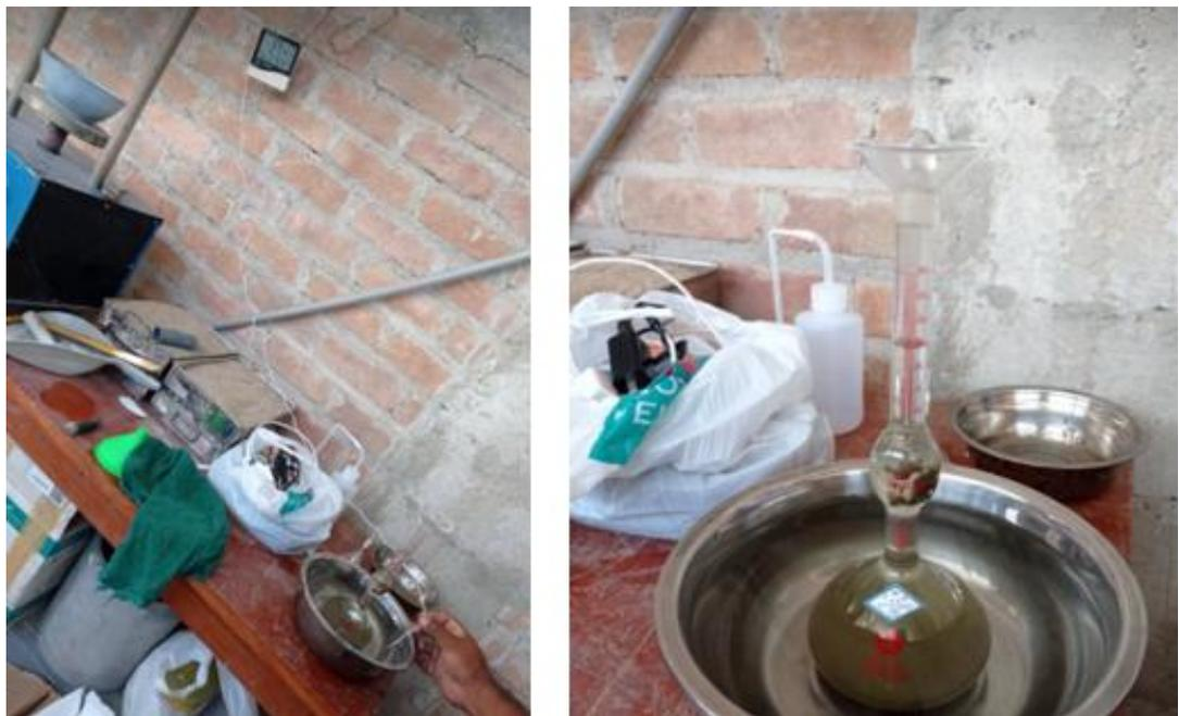
**Figura 51.** Ensayo de peso específico del cemento
