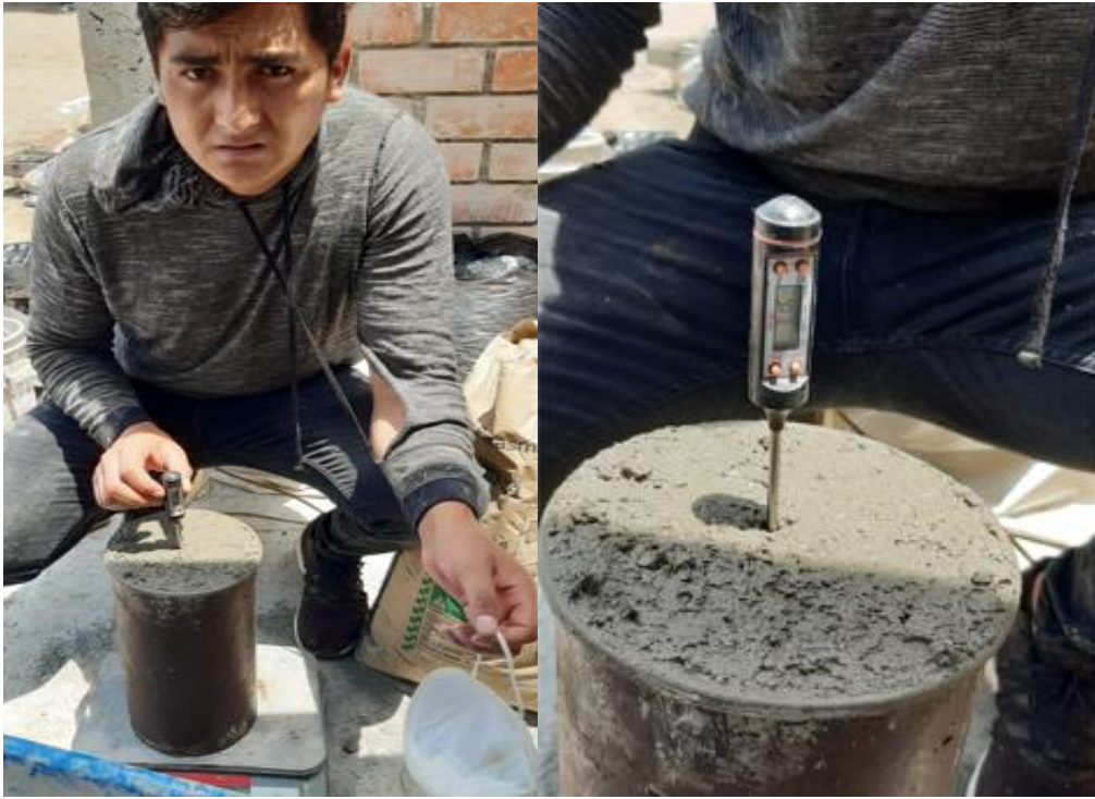
Figura 47: Control de la temperatura del concreto en estado fresco
