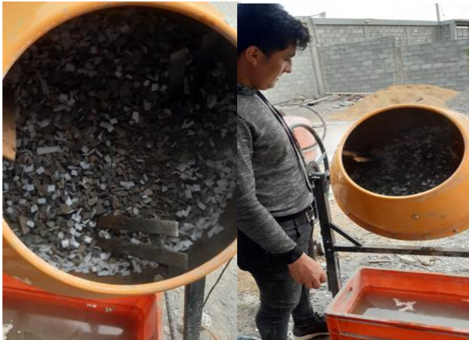
Figura 48: Elaboración del concreto con fibra de poliestireno
