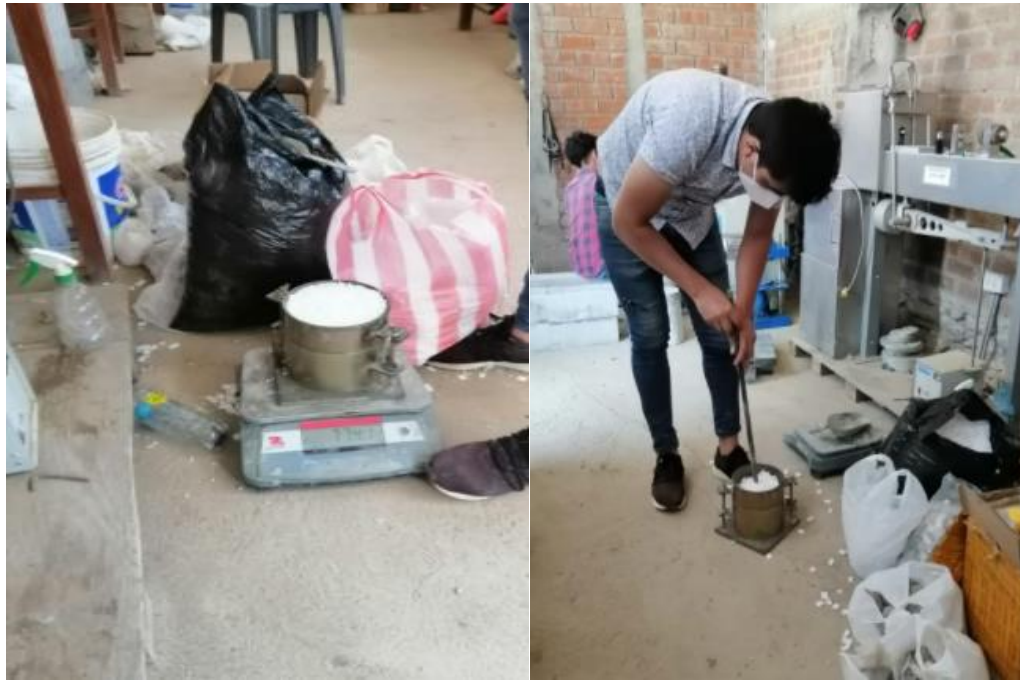
Figura 43: Determinación del peso unitario de la fibra e poliestireno
