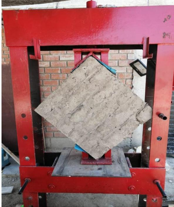
**Figura 36.** Comportamiento del murete sometido a ensayo de compresión diagonal.
