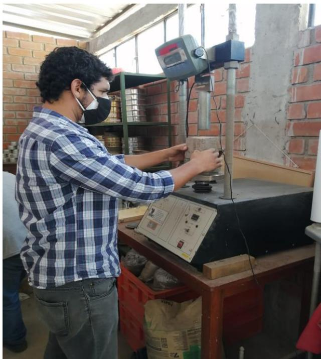
**Figura 26.** Ensayo de resistencia a la compresión de las unidades de adobe.
