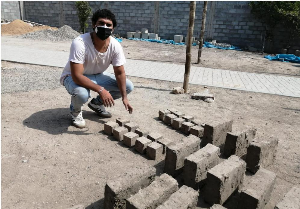
**Figura 24.** Cubos de adobe empleados en el ensayo de resistencia a la compresión.
