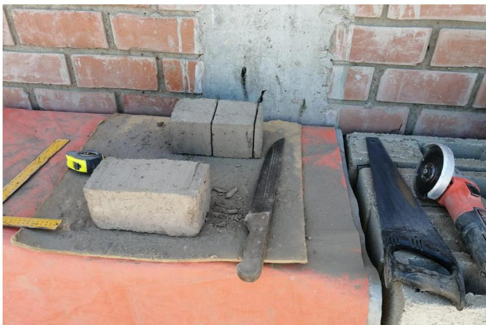
**Figura 25.** Cubos de adobe cortados por la mitad para el ensayo de resistencia a la compresión.
