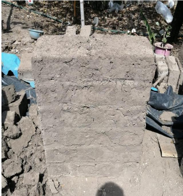
**Figura 34.** Muestra de murete para ensayo de resistencia a la compresión diagonal.
