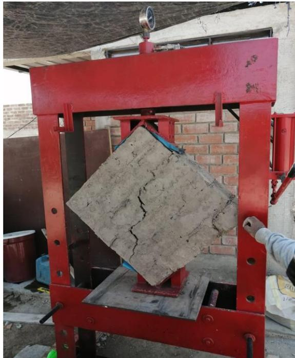
**Figura 37.** Resultado de comportamiento del murete sometido a ensayo de compresión diagonal.
