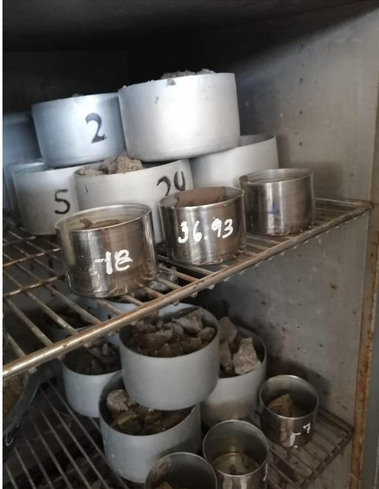
**Figura 11.** Exposición de muestras en el horno antes de ser empleadas en el ensayo de Límite Líquido de los Suelos.
