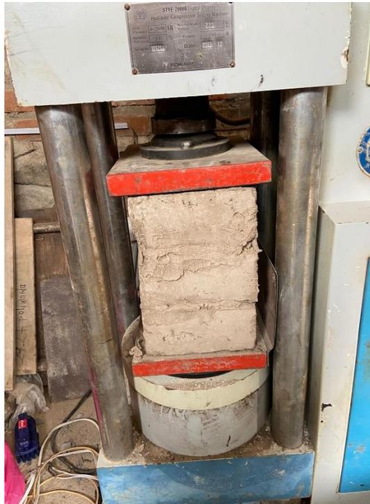
**Figura 33.** Comportamiento de pilas sometidas a ensayo de resistencia a la compresión.
