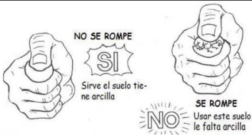
**Figura 15.** Prueba presencia de arcilla o resistencia seca.
