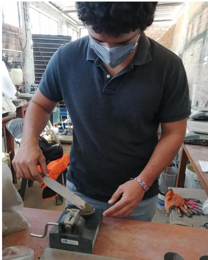
**Figura 10.** Utilización de la Copa Casagrande para el ensayo de Límite Líquido de los Suelos.
