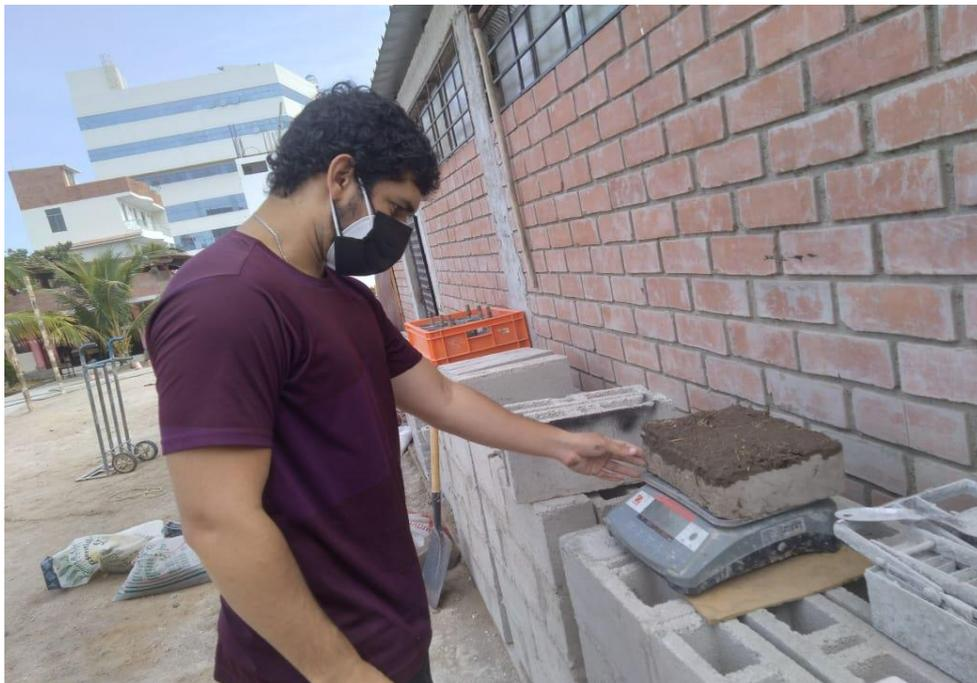
**Figura 30.** Peso de la muestra para ensayo de periodo inicial de absorción (succión).
