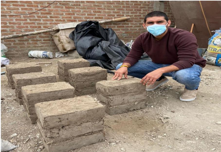
**Figura 31.** Muestras de adobes en pilas para ensayo de compresión.
