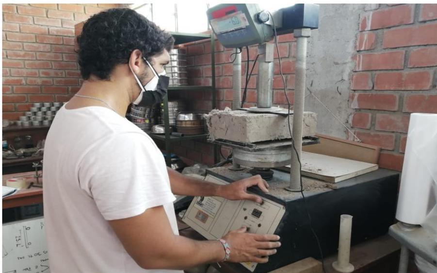
**Figura 28.** Ensayo de resistencia a la flexión de las unidades de adobe.
