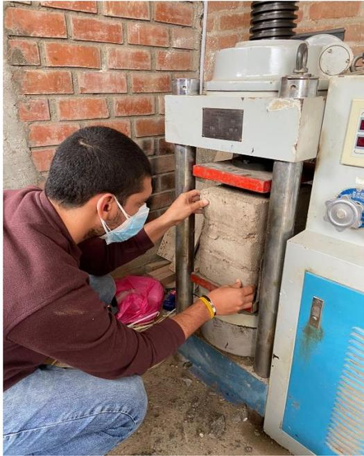
**Figura 32.** Sometimiento de pilas a ensayo de resistencia a la compresión.
