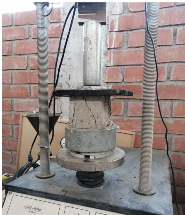
**Figura 27.** Muestra de adobe sometido a ensayo de resistencia a la compresión
