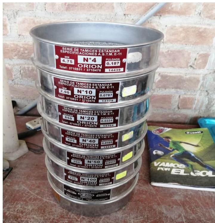
**Figura 8.** Tamices estandarizados para realizar ensayo de análisis granulométrico.
