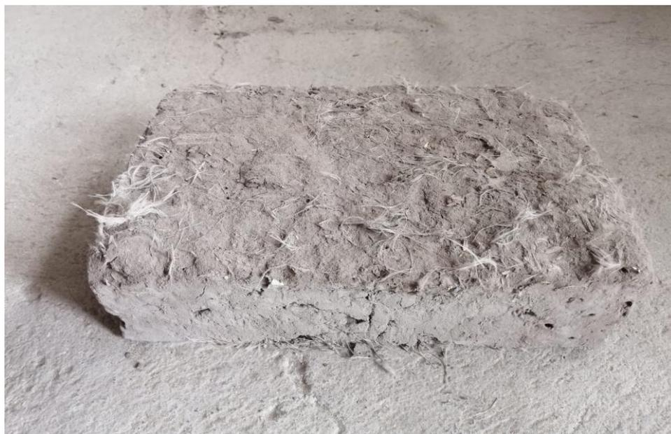
**Figura 23.** Unidad de adobe con fibra de vidrio MAT – 450 MOTOREX.
