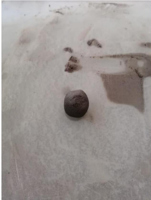
**Figura 17.** Resultado de muestra en prueba de presencia de arcilla.
