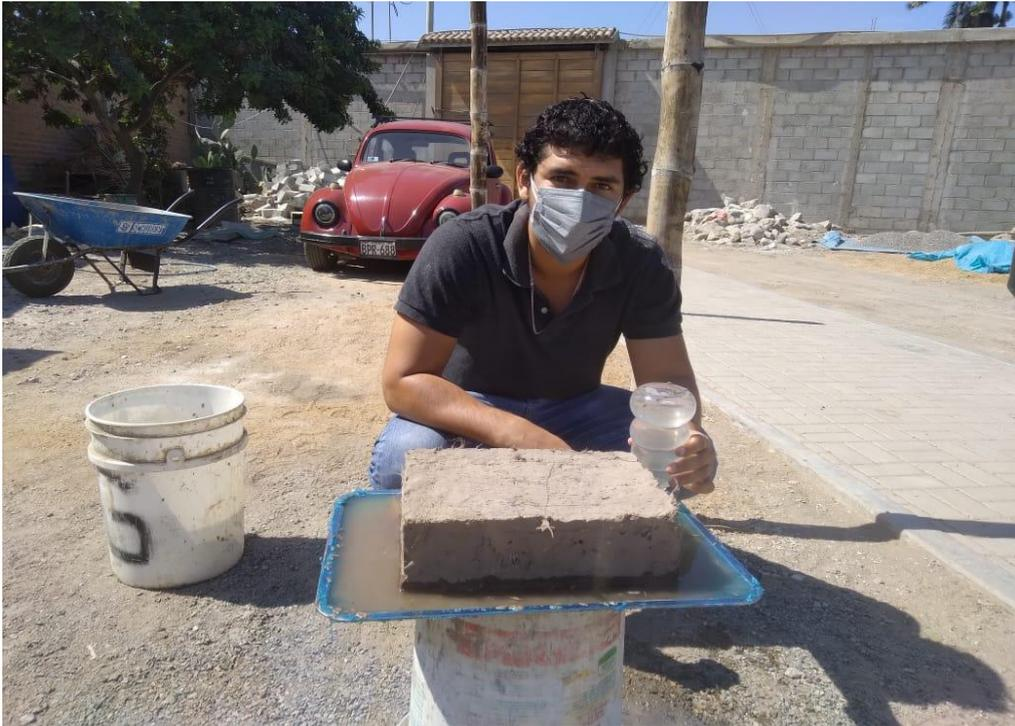
**Figura 29.** Muestra de adobe sometido al ensayo de periodo inicial de absorción (Succión).
