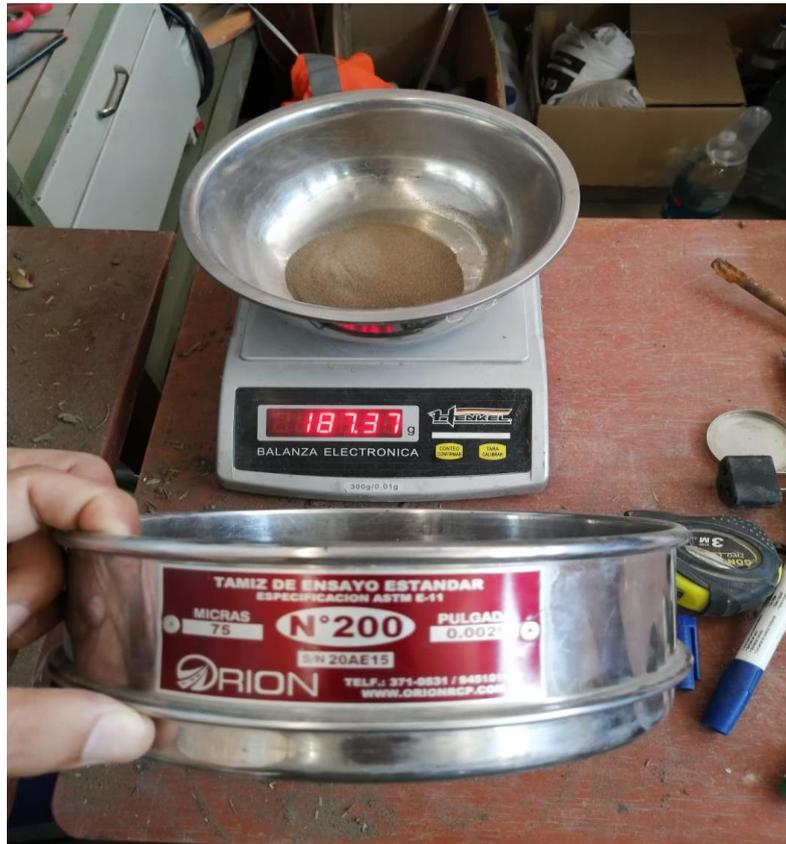
**Figura 9.** Peso de muestra que pasa por la malla N ° 200 en ensayo de análisis granulométrico.
