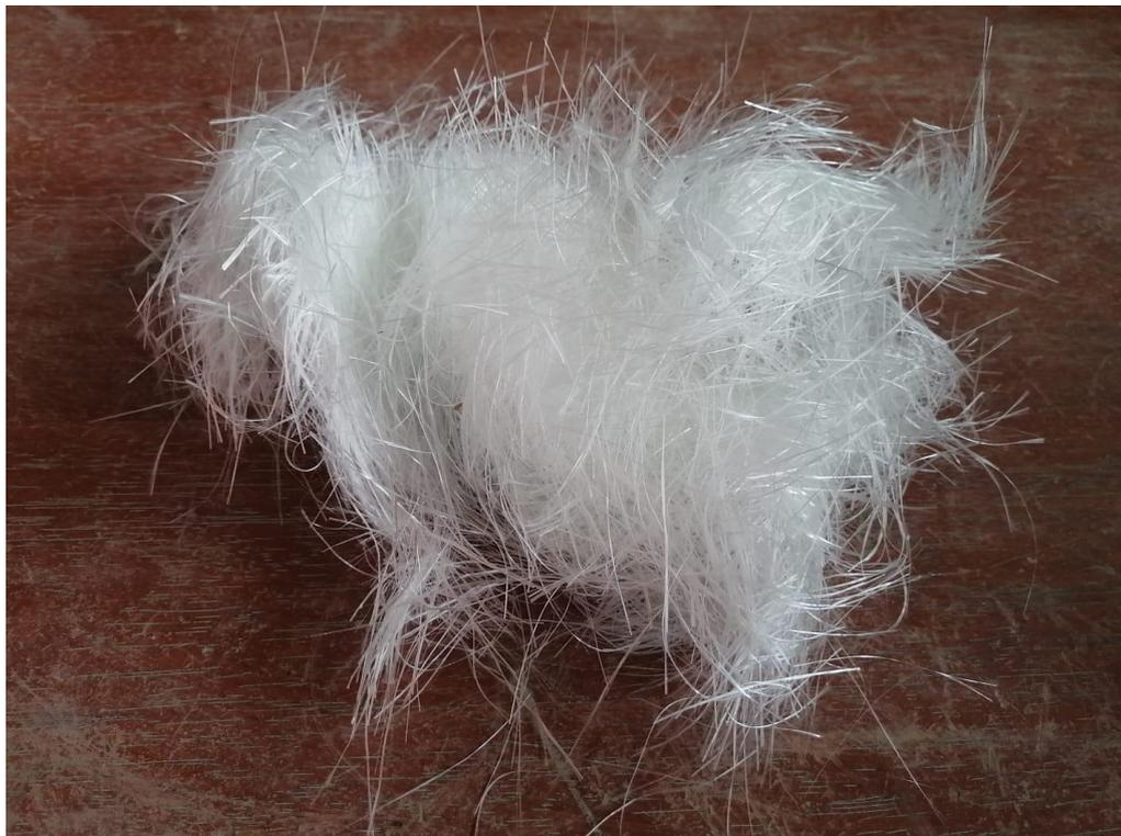
**Figura 7.** Fibra de vidrio MAT – 450 MOTOREX.
