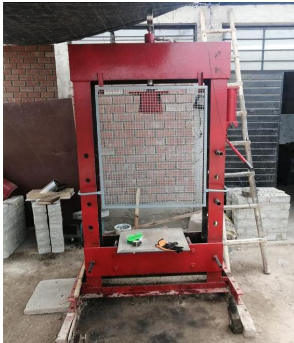
**Figura 35.** Sometimiento de muretes a ensayos de resistencia a la compresión diagonal.
