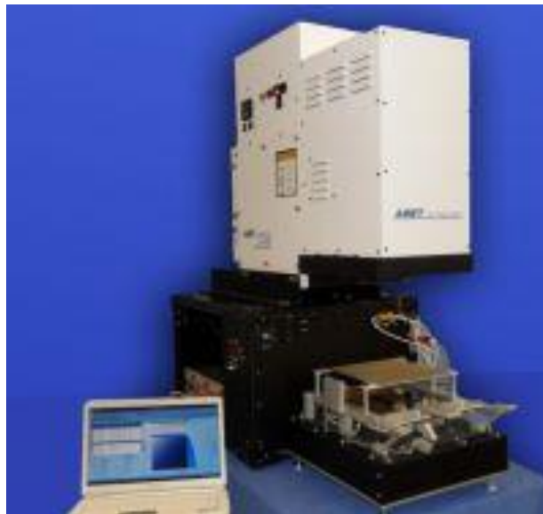
Figura 17.- Módulo de caracterización de paneles fotovoltaicos de la empresa Abet Technologies. Fuente: http://abet-technologies.com/pv-iv-measurement-systems/pv-iv-solutions/
