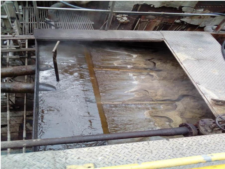
Figura 16. El jugo clarificado se filtra para eliminar el bagacillo y demás impurezas. Fuente: Elaboración propia.
