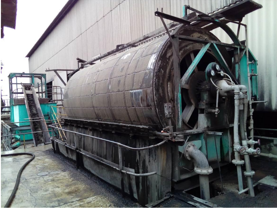
Figura 15. La cachaza obtenida en los clarificadores aún es rica en sacarosa por eso se envía a los filtros en donde a través de vacío se aspira el jugo y se envía al sistema. Fuente: Elaboración propia.
