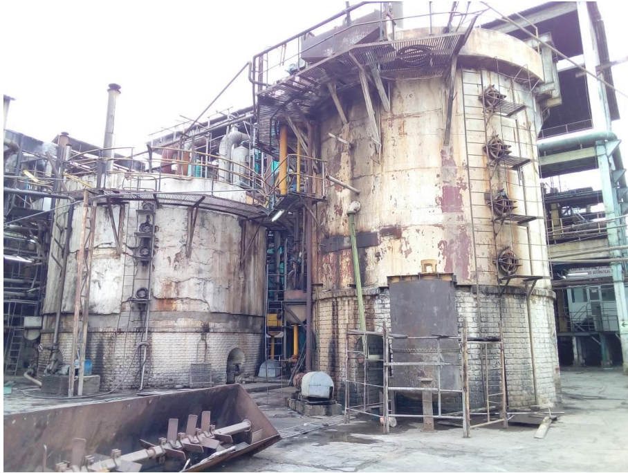
Figura 13. El jugo ingresa al clarificador de arriba hacia abajo, el equipo se compone internamente de 4 niveles, permitiendo clarificar el jugo y obtener la cachaza. Fuente: Elaboración propia.
