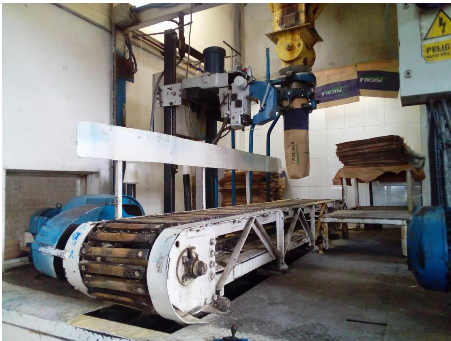
Figura 22. El azúcar se almacena en una tolva, y se descarga en sacos de 50 kg con una balanza se regula el peso, se cosen los sacos con hilo industrial y se almacenan. Fuente: Elaboración propia.
