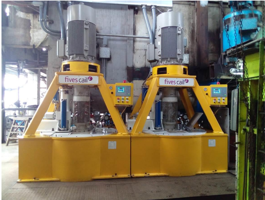
Figura 21. La masa formada en los Vacuum panes se descarga a las centrífugas en donde se inicia un proceso de separación por densidades, obteniendo azúcar y melaza. Fuente: Elaboración propia.
