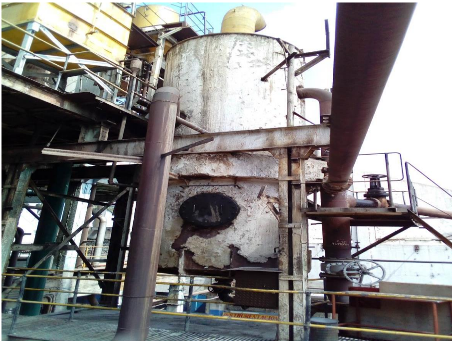
Figura 12. En este equipo al jugo de caña se le añade floculante permitiendo ganar peso a las partículas de impurezas presentes en el jugo ayudando a sedimentarlas. Fuente: Elaboración propia.
