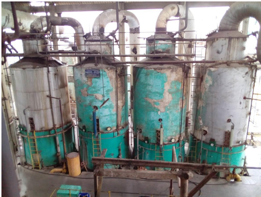
Figura 18. Los evaporadores se constituyen de cuatro cuerpos de simple efecto, el flujo de jugo va de izquierda a derecha y al final del proceso se obtiene jarabe. Fuente: Elaboración propia.
