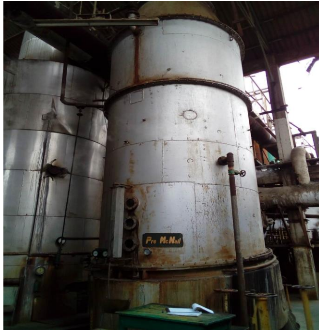
Figura 17. El jugo filtrado ingresa a los equipos pre - evaporadores, permitiendo a través de temperatura aumentar la concentración de sacarosa presente en el jugo. Fuente: Elaboración propia.
