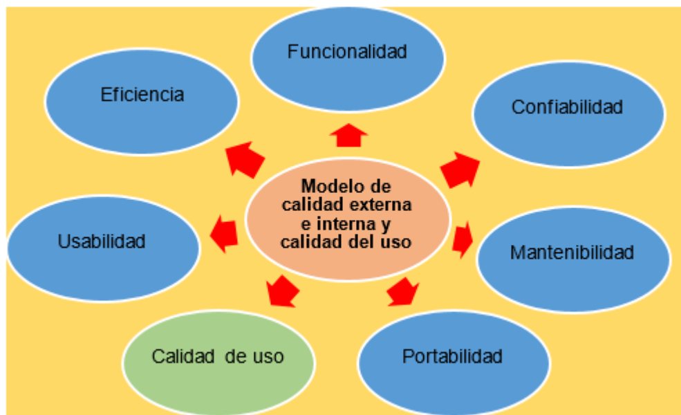
Figura 2. Modelo de evaluación de la calidad interna y externa. Fuente: (TEAMEVOLUCION BLOG, 2016)
