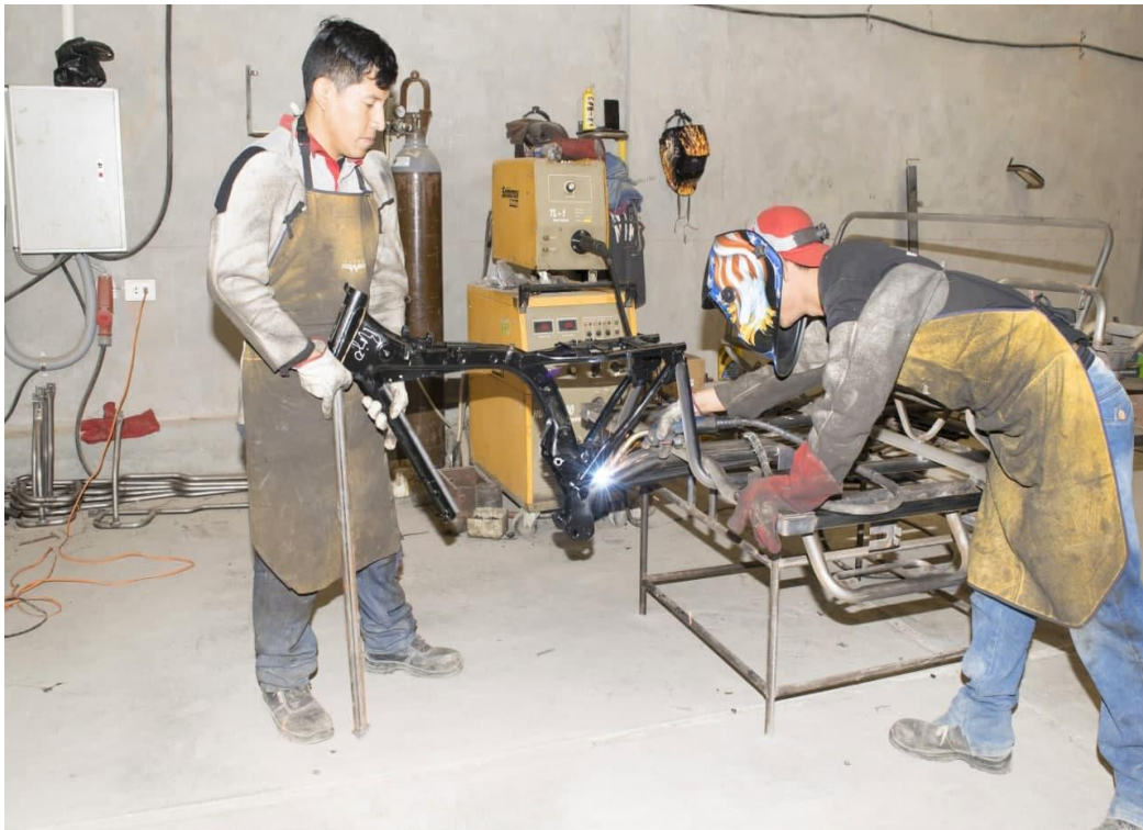
Figura 12 - Soldadura de partes
