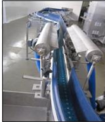
Figura 68. Cuchillas de aire a la salida del túnel de vapor.
