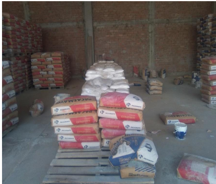
Figura 03: Falta de orden y limpieza en el área de cemento
