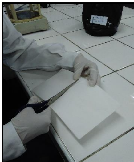
Figura 5.7 Preparación de cartuchos para la extracción
