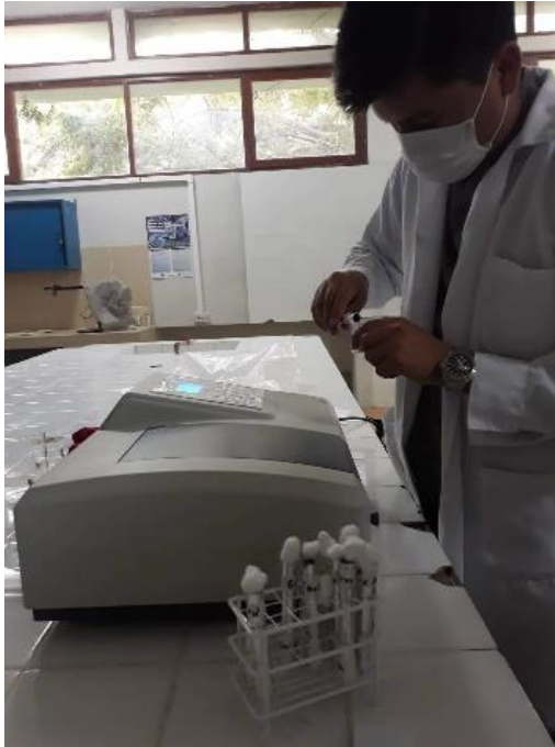
Figura 42: Lectura de muestra en el espectrofotómetro.
