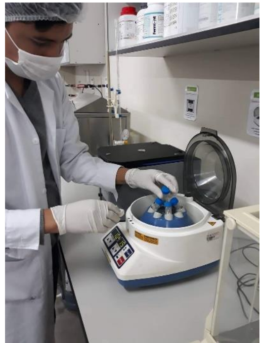
Figura 39: Centrifugación de la muestra para que sean homogéneas.
