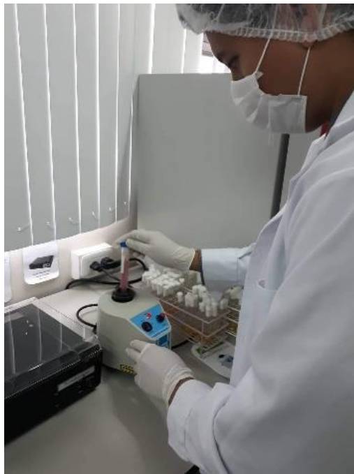
Figura 38: Muestra en vortex para que las partículas entren en contacto.
