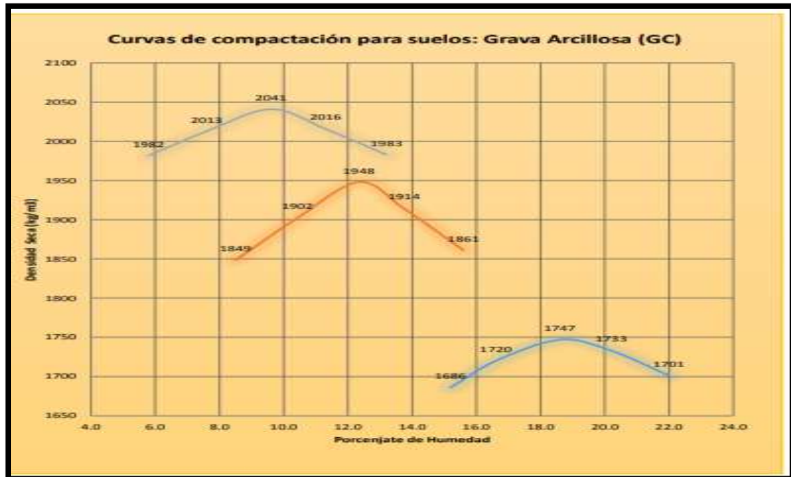
Figura 77: Gráfica de las curvas de compactación para la subdivisión del suelo grava arcillosa (GC) con valores máximos, promedios y mínimos.
