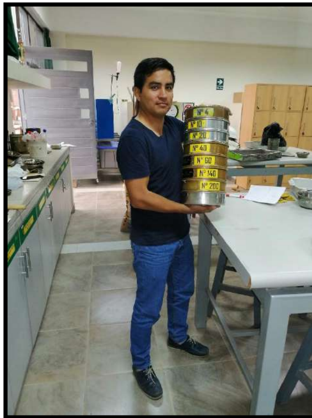
Figura 58: Elaboración del ensayo de análisis granulométrico por tamizado. Fuente: Elaboración propia.
