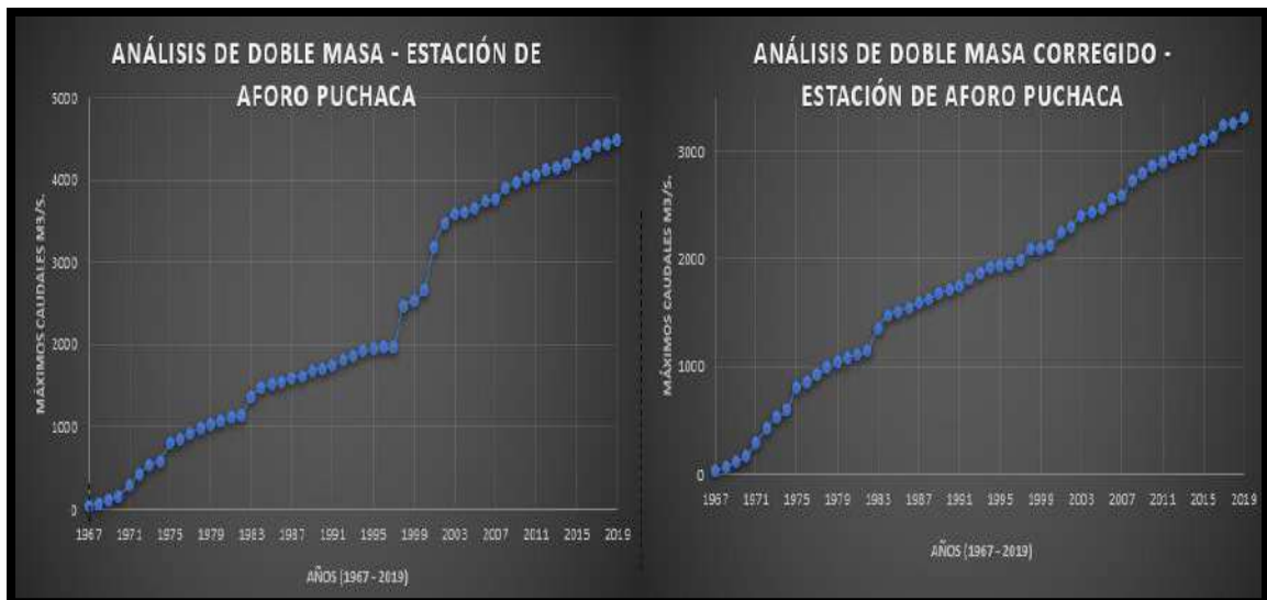
Figura 36: Análisis de doble masa de la estación de aforo Puchaca. Fuente: Elaboración propia usando el software.
