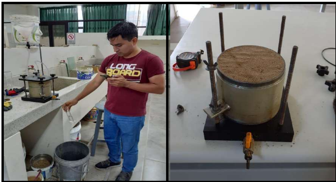
Figura 61: Ensayo de permeabilidad para suelos granulares. Fuente: Elaboración propia.
