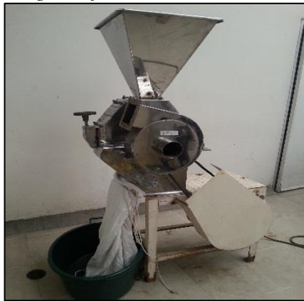
Figura 4.6 Molienda de la semilla de Moringa oleifera, en un molino de martillo .
