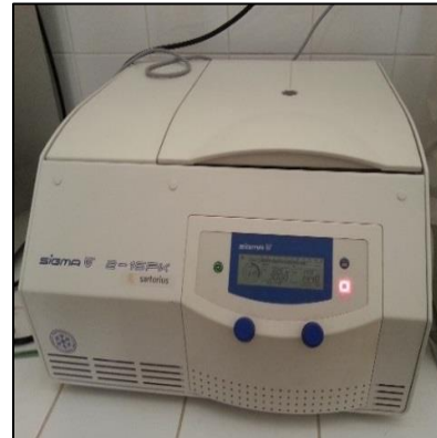
Figura 4.16 Centrifugación del aceite de moringa a 3000 rpm por 20 minutos a 25°C en una Centrifuga Sigma modelo 2-16PK.
