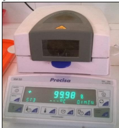
Figura 4.8 Medición de la humedad de la harina de las semillas de Moringa oleifera, en un equipo termobalanza modelo Precisa XM50.
