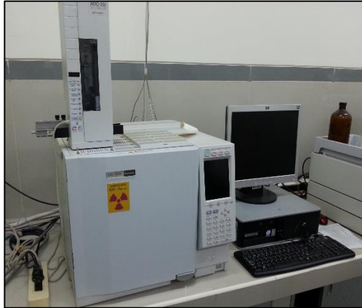
Equipo, Cromatógrafo de gases, Shimadzu, modelo GC-2010, Japon
