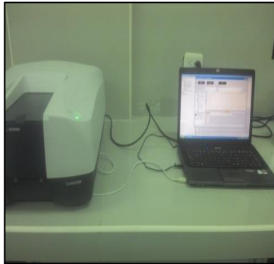
Figura 4.21 Lectura del espectrofotómetro para determinación del índice de anisidina
