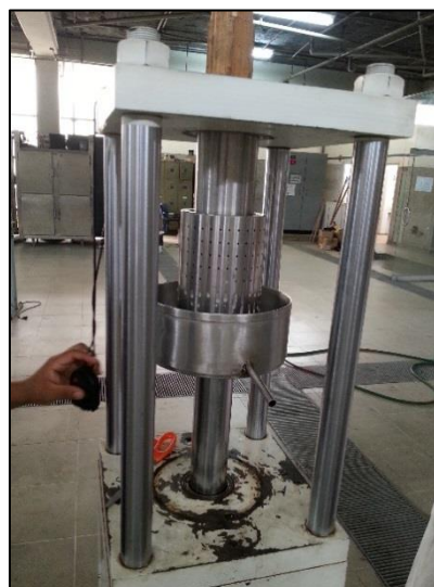
Figura 4.12 Extracción por prensado en frío (25°C) de semillas de moringa a una presión de 360 \pm 10 bar por 25 min.
