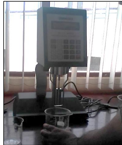
Figura 4.24 Determinación de la viscosidad mediante la utilización del viscosímetro Brookfield DVIII.
