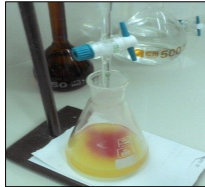
Figura 4.22 Titulando con NaOH para la determinación del índice de acidez
