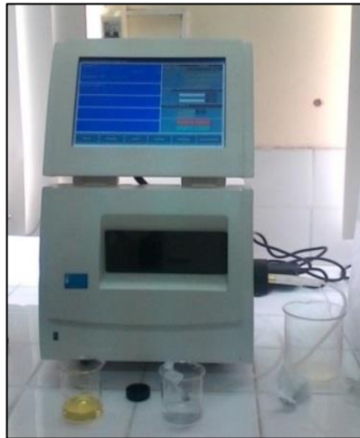
Figura 4.23 Determinación de la densidad del aceite de moringa en un densímetro digital Rudolph DDM 2b911.
