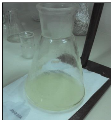
Figura 4.20 Determinación del Índice de peróxido (No detectable)
