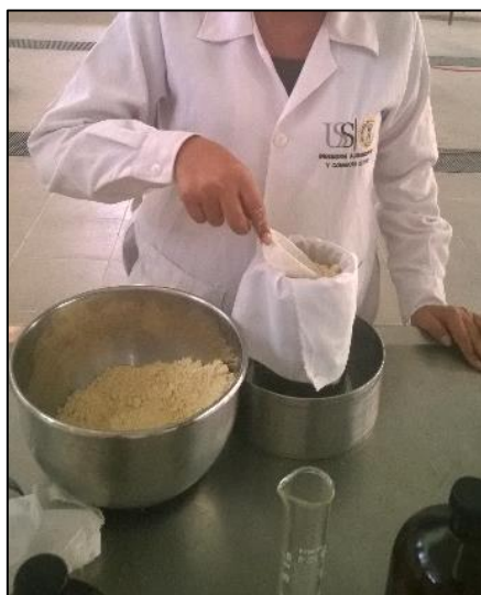
Figura 4.11 Acondicionamiento de la semilla molida de moringa en el equipo de prensado.
