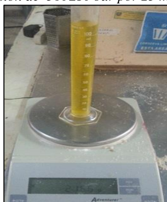
Figura 4.14 Pesado y medición del volumen del aceite virgen de moringa.
