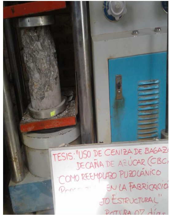
Foto 19 Ensayo a compresión: rotura especímenes
