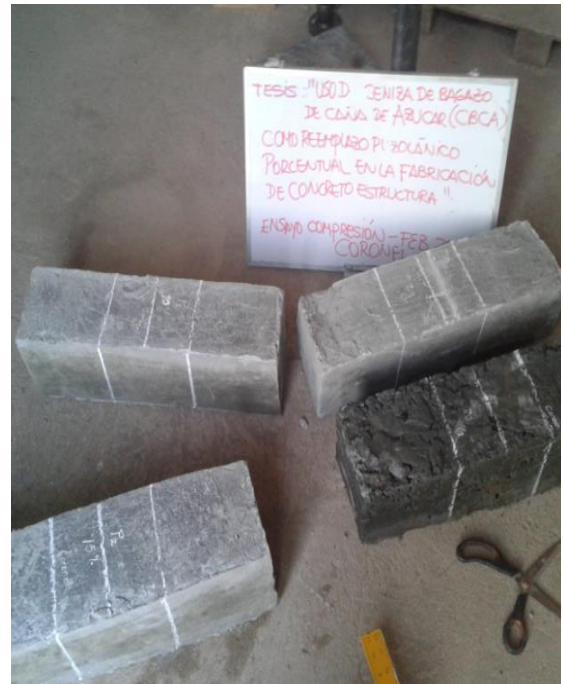
Foto 20 Ensayo para determinar Modulo Elástico y segmentación en vigas
