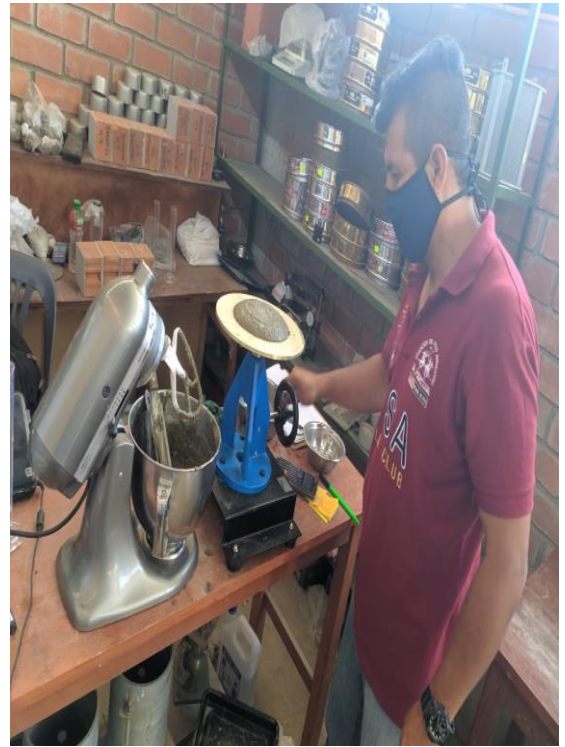
Foto 5 Ensayo de flujo para determinar agua necesaria para la mezcla experimental
