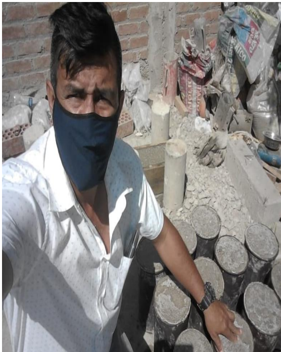
Foto 18 Desmolde y curado de especímenes
