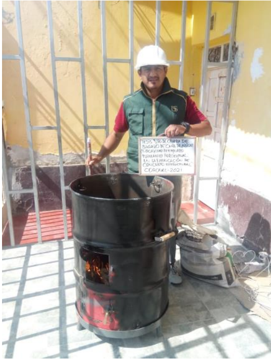
Foto 1 Proceso de quema y obtención en bruto la CBCA
