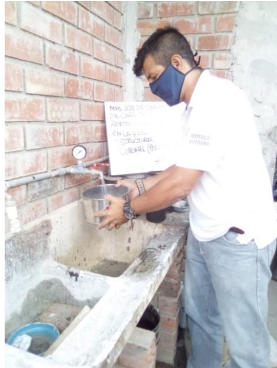
Foto 3 Pesaje y proceso del ensayo de finura por lavado sobre la malla #325
