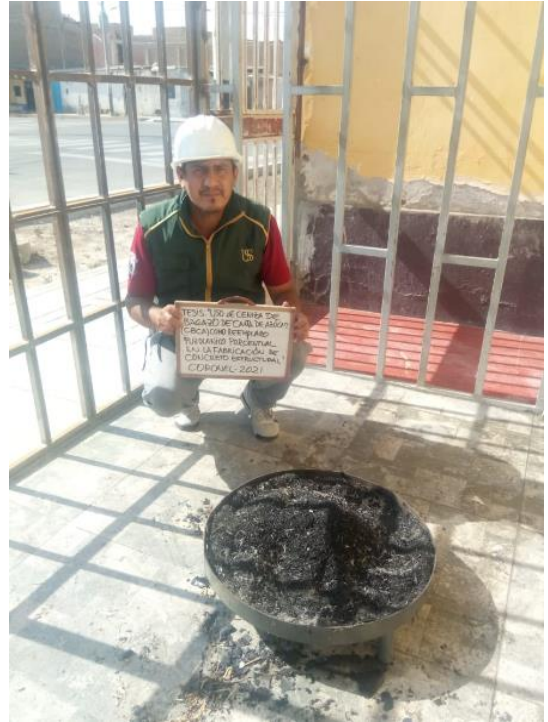
Foto 1 Proceso de quema y obtención en bruto la CBCA
