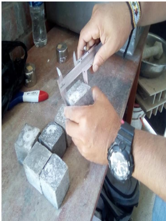
Foto 6 Medida de especímenes cúbicos y ensayo de rotura para determinar el Índice Puzolánico
