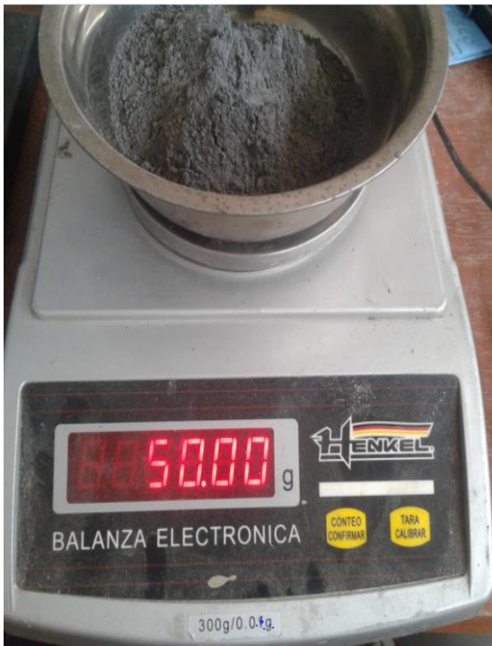
Foto 4 Pesaje y Ensayo Peso Específico de la CBCA
