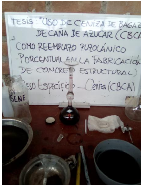
Foto 4 Pesaje y Ensayo Peso Específico de la CBCA
