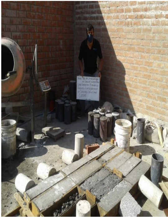
Foto 17 Vaciado a especímenes cilíndricos y prismáticos
