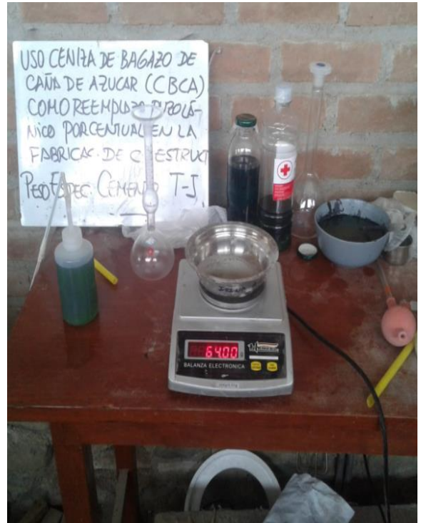
Foto 7 Ensayo de Peso Específico al Cemento Portland Tipo I
