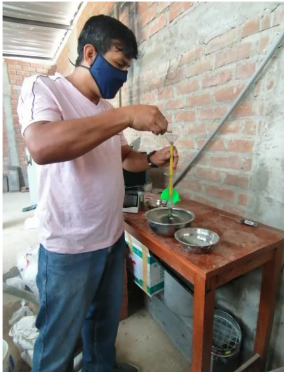
Foto 7 Ensayo de Peso Específico al Cemento Portland Tipo I
