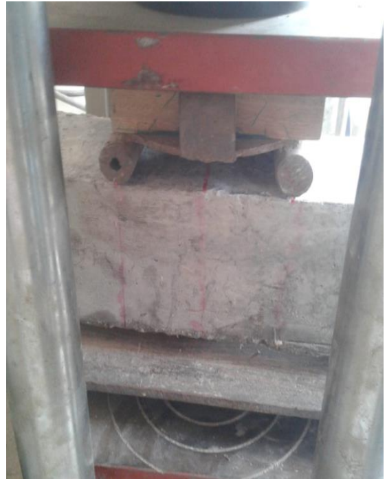
Foto 21 Ensayo a Flexión en vigas prismáticas
