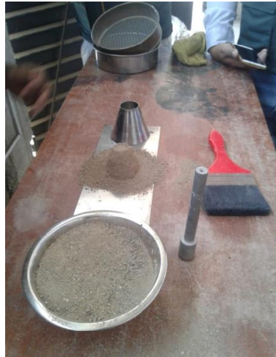
Foto 13 Ensayo de peso específico y consistencia del agregado fino
