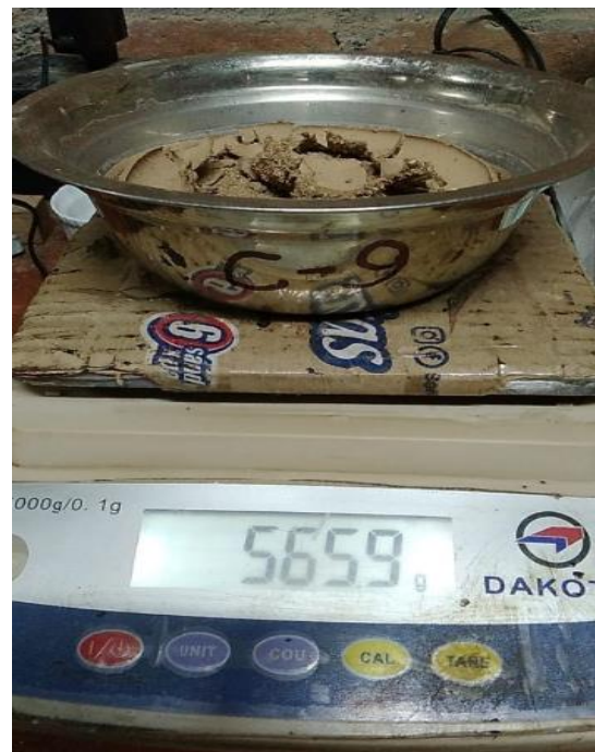
Foto 13 Ensayo de peso específico y consistencia del agregado fino
