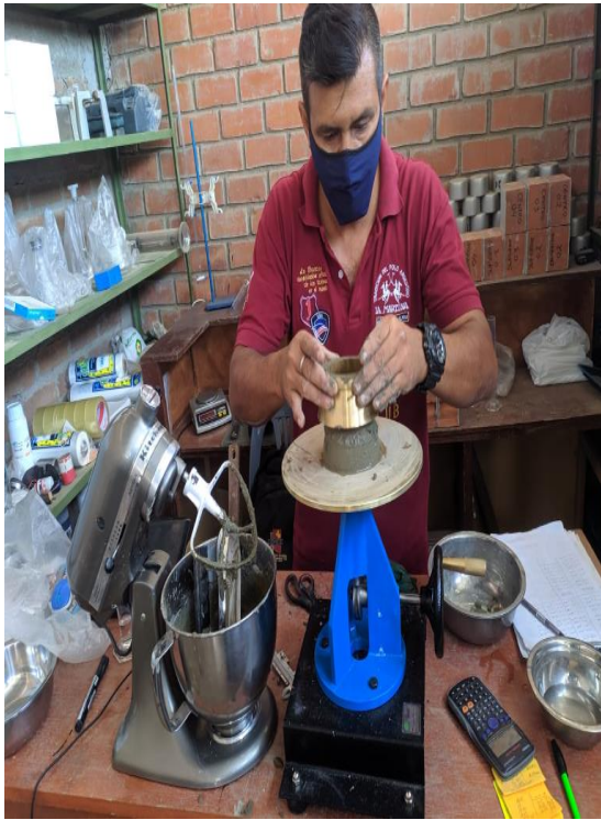
Foto 5 Ensayo de flujo para determinar agua necesaria para la mezcla experimental
