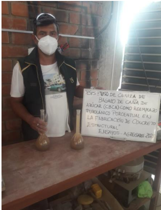
Foto 13 Ensayo de peso específico y consistencia del agregado fino
