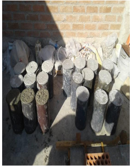
Foto 17 Vaciado a especímenes cilíndricos y prismáticos
