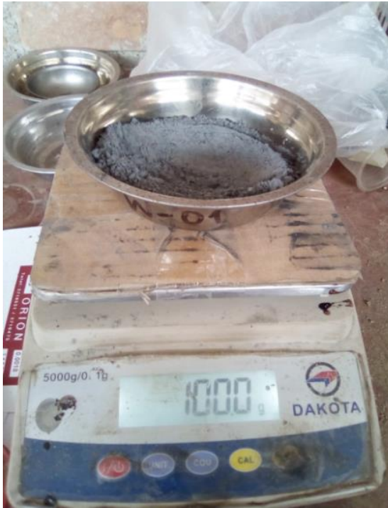
Foto 3 Pesaje y proceso del ensayo de finura por lavado sobre la malla #325
