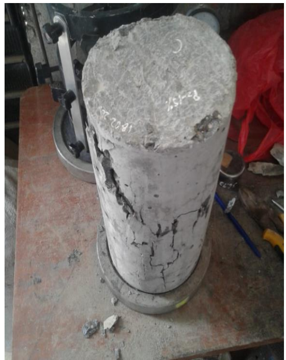
Foto 22 Rotura de especímenes cilíndricos y prismáticos
