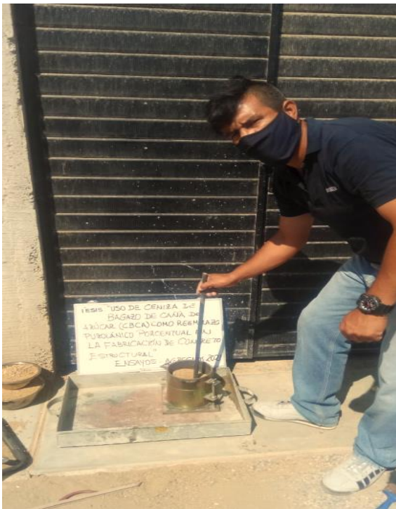
Foto 10 Varillado en ensayos del agregado pétreo compactado
