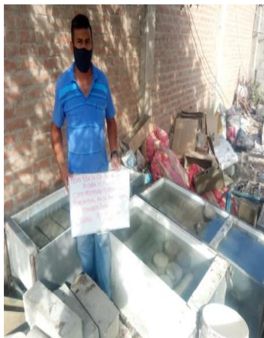
Foto 18 Desmolde y curado de especímenes
