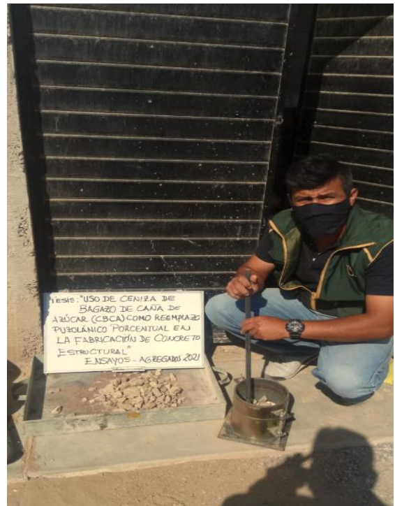
Foto 10 Varillado en ensayos del agregado pétreo compactado
