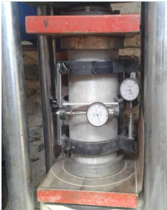
Foto 20 Ensayo para determinar Modulo Elástico y segmentación en vigas
