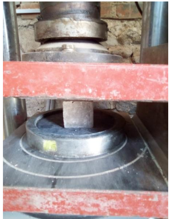
Foto 6 Medida de especímenes cúbicos y ensayo de rotura para determinar el Índice Puzolánico
