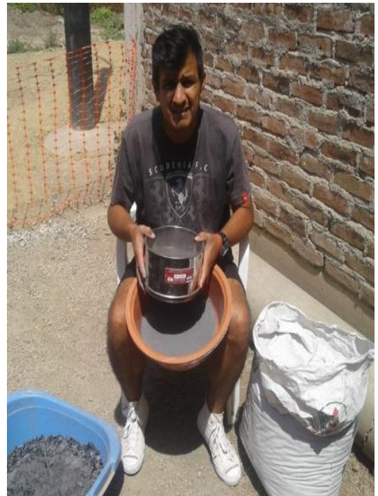
Foto 2 Proceso de molienda y Tamizado de CBCA
