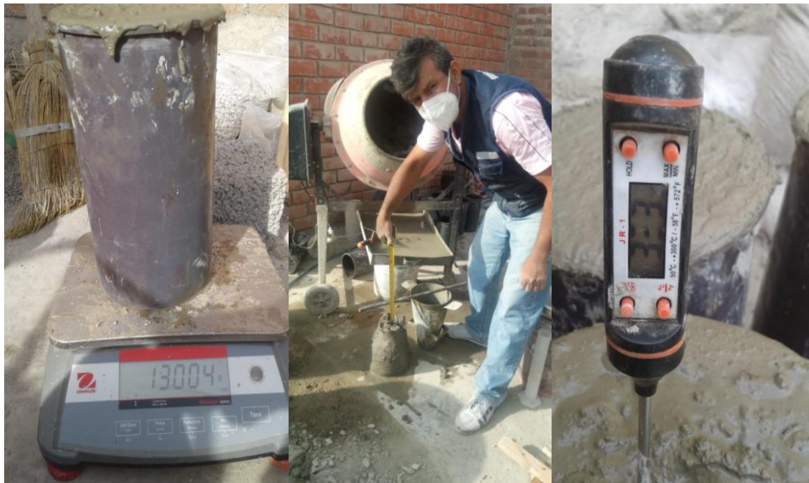
Foto 16 Ensayos en estado fresco del hormigón: Peso unitario, SLUMP y Temperatura
