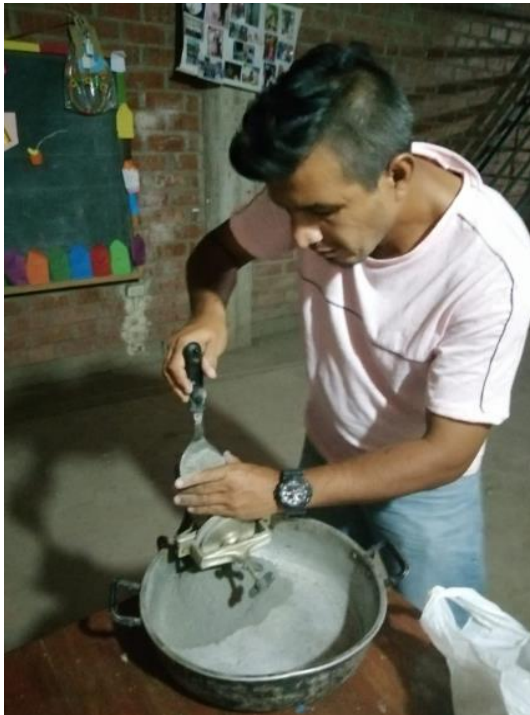
Foto 2 Proceso de molienda y Tamizado de CBCA
