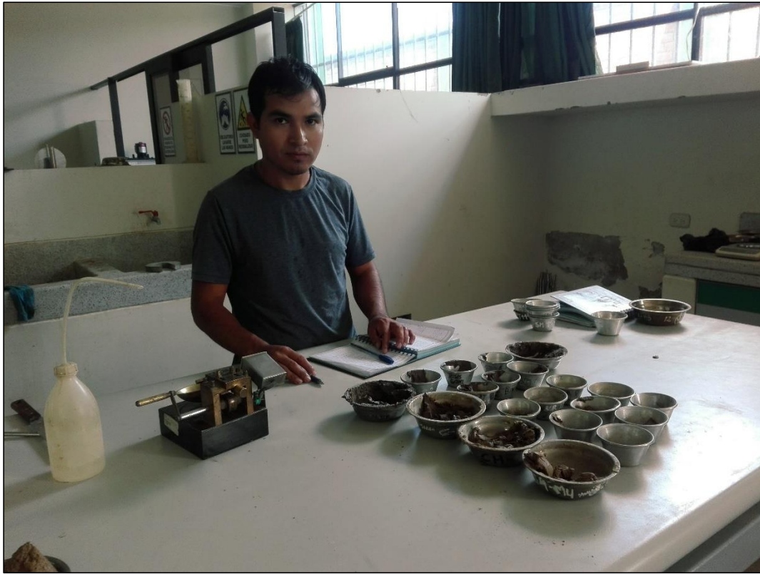
Figura 11 Muestras para obtener los índices de plasticidad
