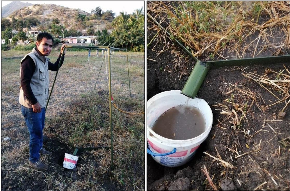
Figura 23 Haciendo la simulación de lluvia en el campo
