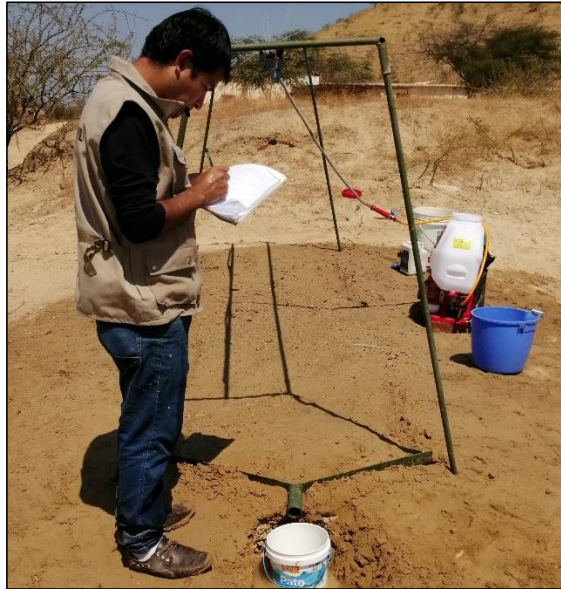
Figura 13 Ensayos realizados para lograr la intensidad requerida
