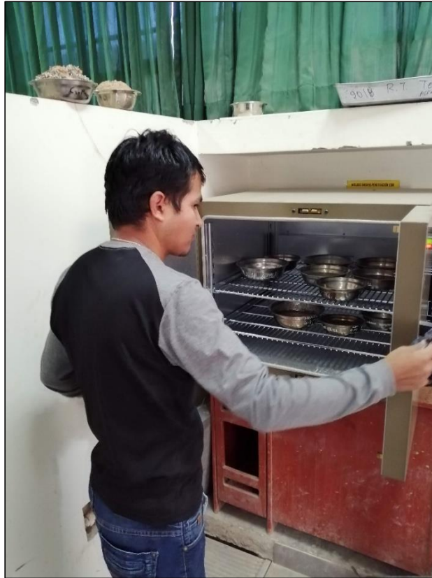
Figura 25 Secando el material obtenido después de los eventos hidrológicos simulados
