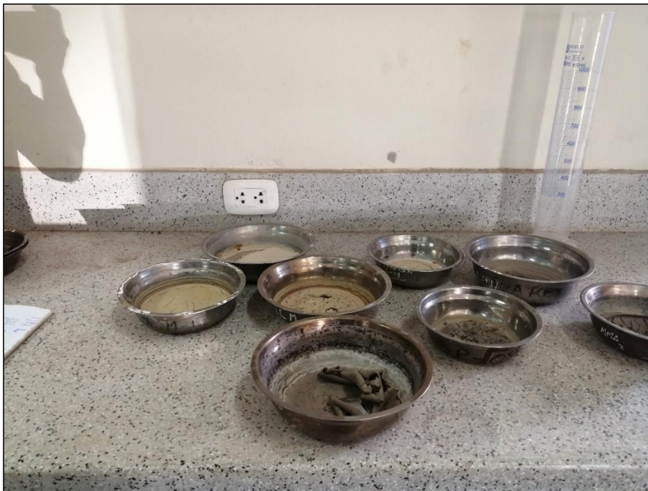
Figura 26 Material erosionado obtenido de los eventos hidrológicos simulados
