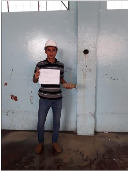
Imagen N° 5 Corazón diamantino 1 del Módulo A
