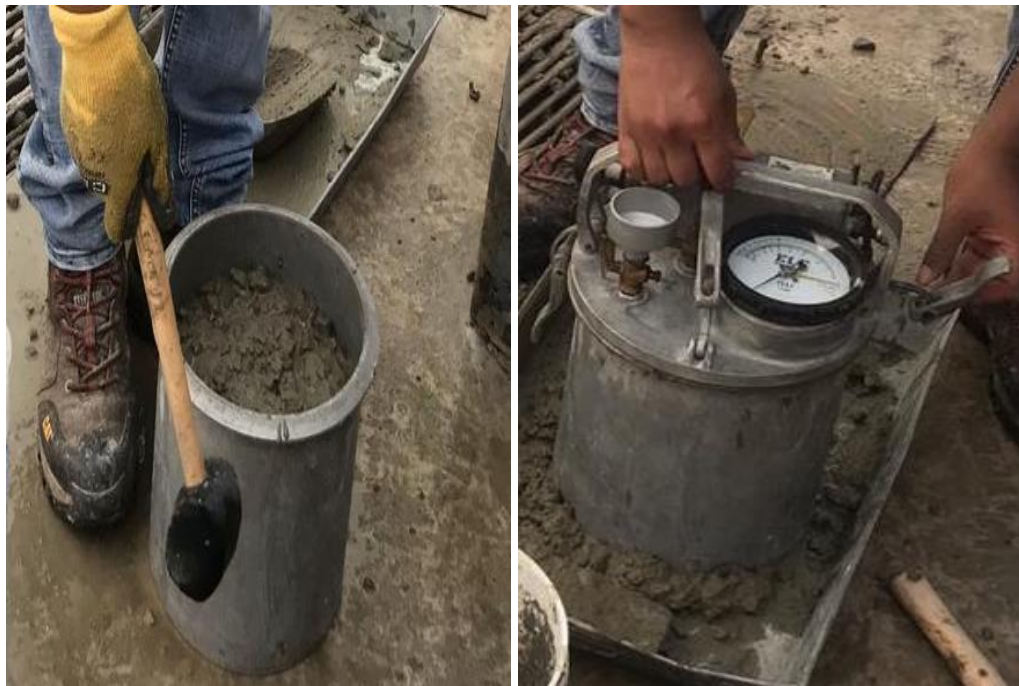
Figura 61: Peso unitario y contenido de aire del concreto
