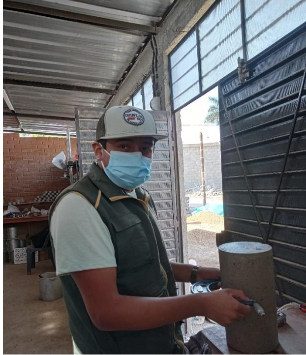
Figura 64: Medida del diámetro de probeta de concreto
