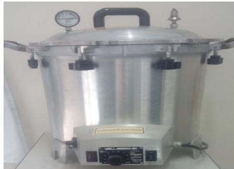
Figura 10: Autoclave para esterilización de materiales del laboratorio PACTUSS.
