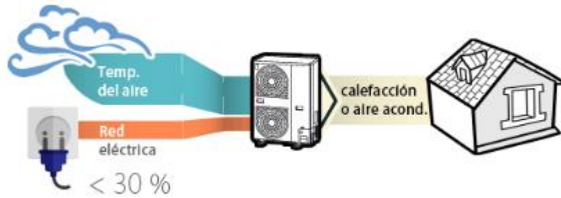
Figura 6. Esquema de funcionamiento de una bomba de calor aerotérmica. Fuente: (Gómez, 2018).
