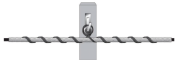
Sistema de Suspensión Instalado
