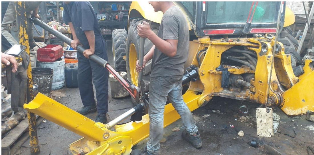
Figura 86: Proceso de afloje de tapa de cilindro. Fuente: Propio.
