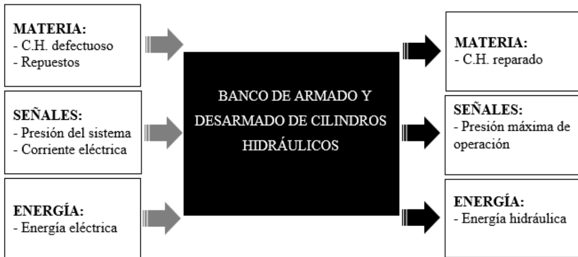
Figura 30: Caja negra, banco de armado y desarmado de cilindros hidráulicos. Fuente: Propio.
