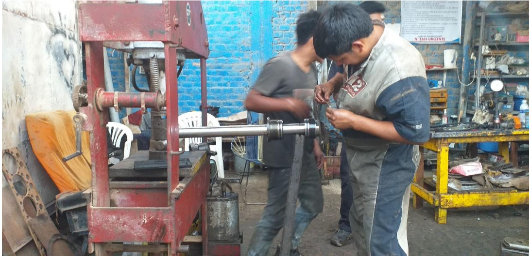
Figura 85: Proceso de afloje de tuerca de vástago. Fuente: Propio.
