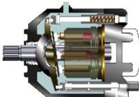
Figura 10: Vista interna de una bomba de pistones axiales.
