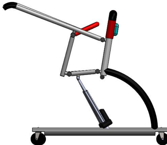
Figura 80: Vista frontal de mecanismo modelado en SolidWorks 2018 Fuente: Elaboración propia.
