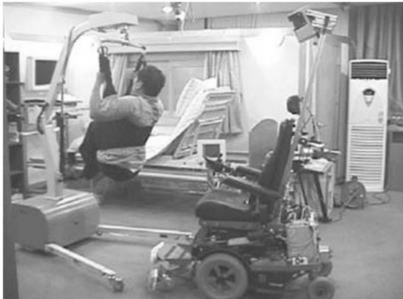
Figura 8: Diseño de elevador desarrollado por el NIST
