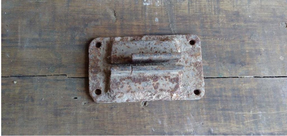
Ilustración 3: Trampa usada para elaborar estribos de forma manual
