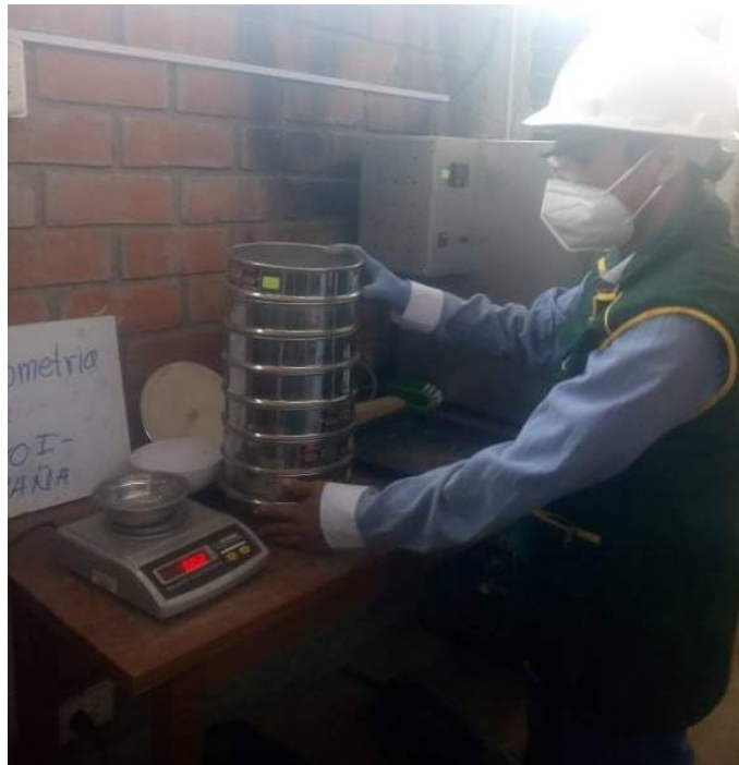
Fotografía 10: Tamizado del agregado
