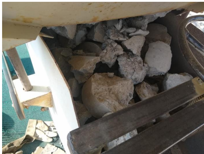
Fotografía 8: Proceso de triturado del agregado reciclado
