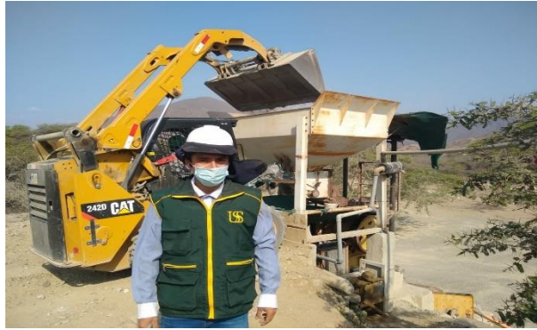
Fotografía 6: proceso de llenado de la tolva con agregado reciclado
