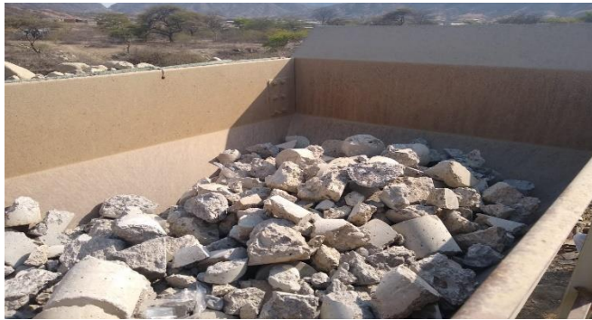
Fotografía 7: Agregado reciclado en la máquina trituradora
