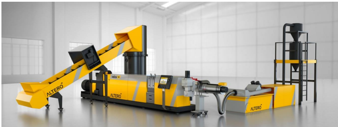
Figura 28. Compactador para reciclaje posconsumo de envases PET
