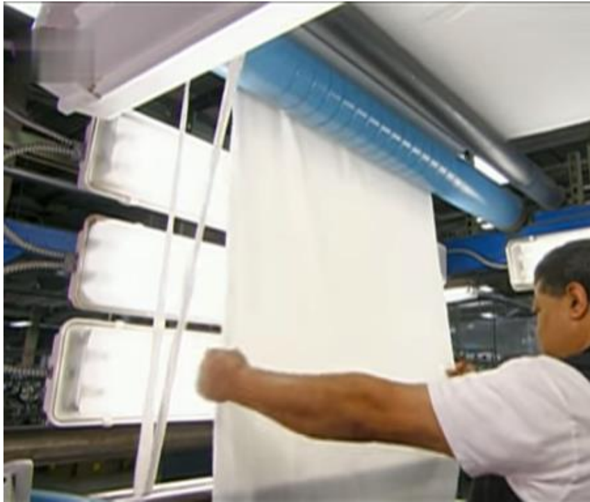
Figura 89. Inspección de la tela poliéster
