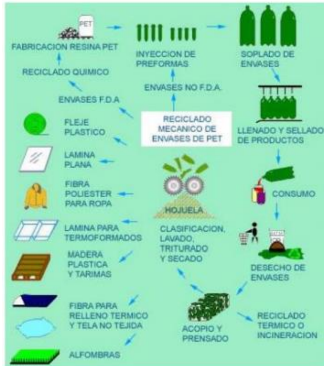
Figura 27. Procedimiento del reciclado de PET
