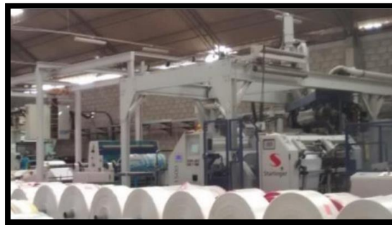
Figura 17. En el proceso de laminación se recubre la manga tejida por ambas caras con una lámina de polietileno y UV.
