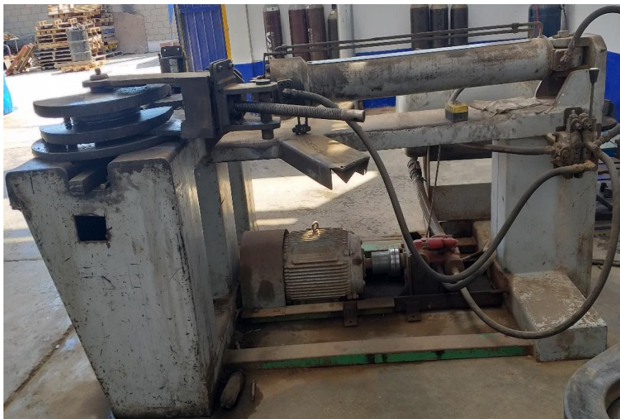
Figura 17 Maquina dobladora de 40 HP.
