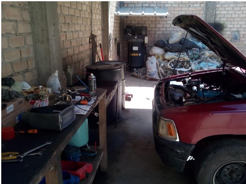
Figura 12. Imagen de banco de trabajo, herramientas desordenadas, espacio de trabajo reducido, en el fondo se observa la disposición inadecuada de sacos con materiales, obstaculizando el ingreso a la compresora.
