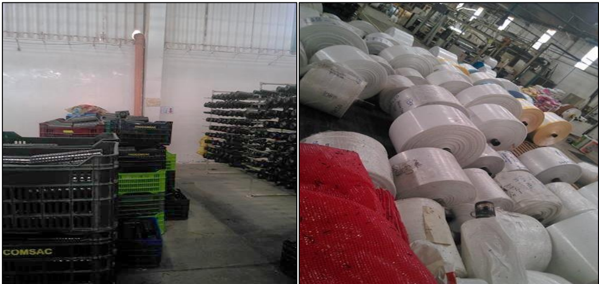
Figura 42: Filetas y caja de bobinadoras sin orden y señalización
