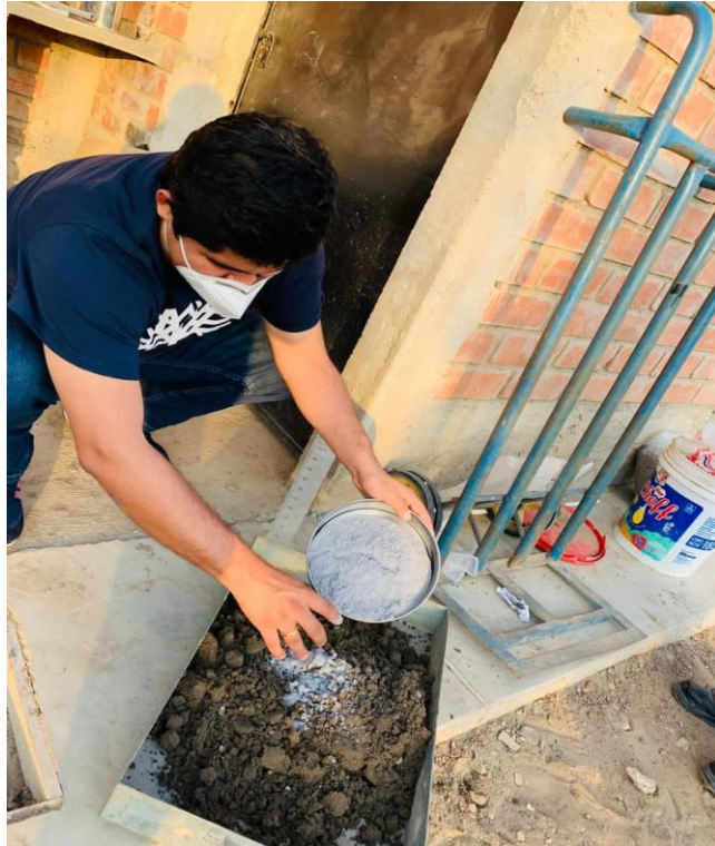
Figura 87. Mezcla de suelo, ceniza y agua.
