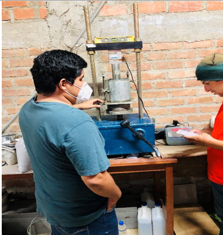
Figura 89. Ejecución del ensayo para determinar resistencia suelo ceniza.
