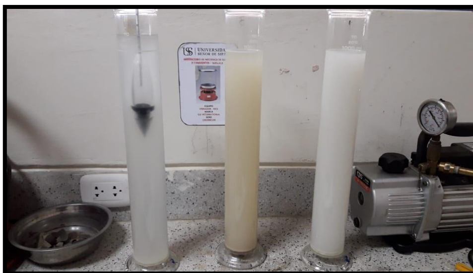
Figura 30: probetas de 1000 ml introduciendo el hidrómetro para las lecturas correspondientes, fuente (elaboración propia)
