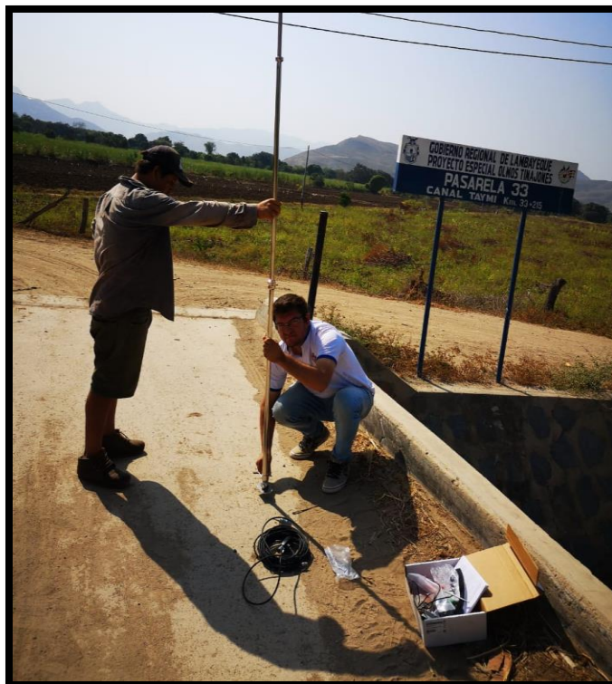
Figura 68: Instalación del correntómetro electromagnético o molinete para la medición de la velocidad del canal en el tramo estudiado, fuente (elaboración propia)
