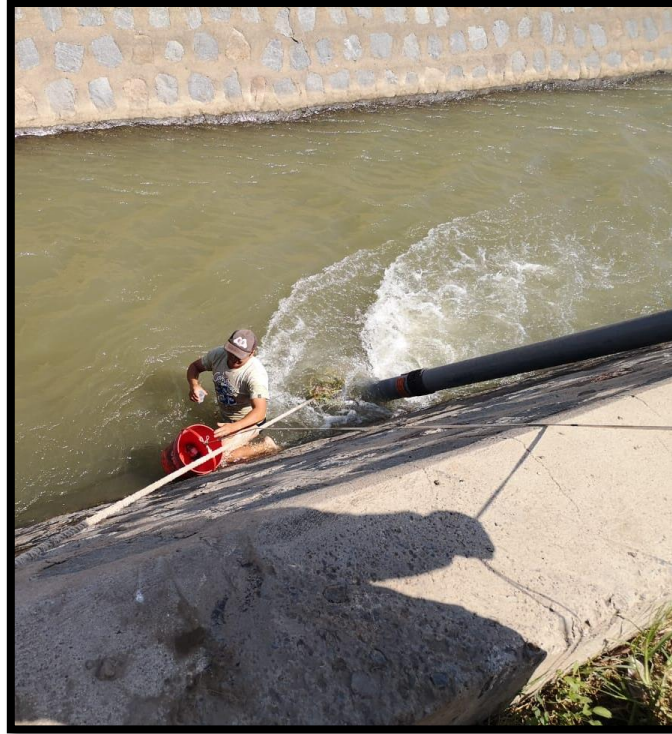
Figura 26: toma de muestras de agua a diferentes profundidades, Fuente (elaboración propia)
