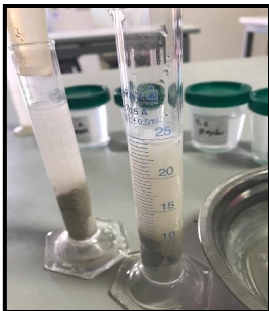
Figura 29: probetas de 25 ml mezclado con el defloculante lista para agitar, fuente (elaboración propia)
