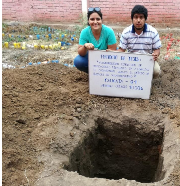
Ilustración 32: Calicata N°1 de la IE. N° 10006
