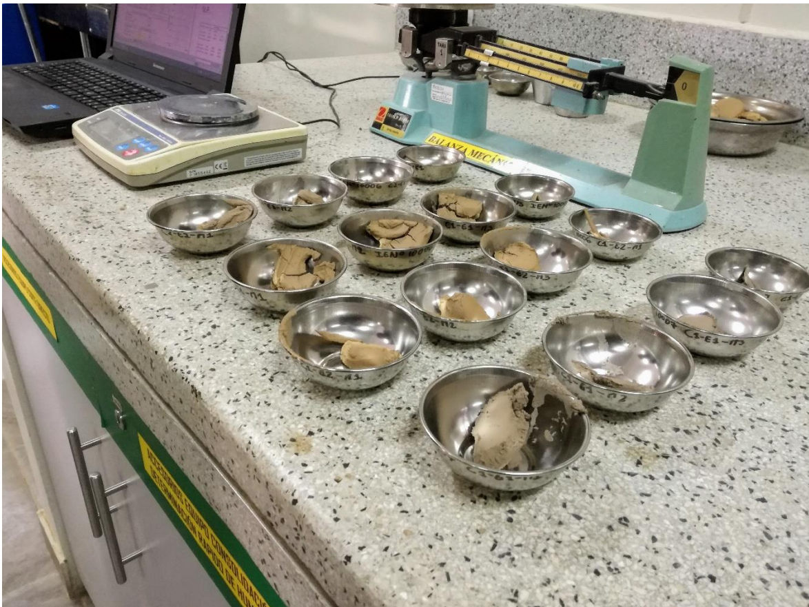
Ilustración 43: Muestras secas y pesadas luego de los Ensayos de Límite de Atterberg
