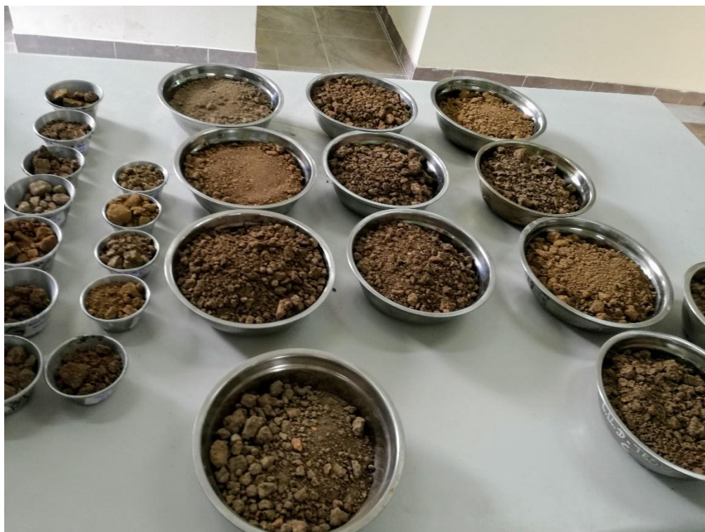
Ilustración 39: Muestras secas en el horno, para el Ensayo de contenido de humedad y el Ensayo de Límite de Atterberg
