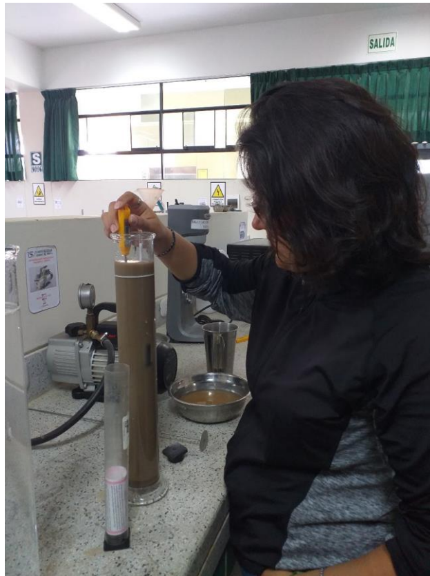
Ilustración 46: Medición con el hidrómetro de la sedimentación en las muestras
