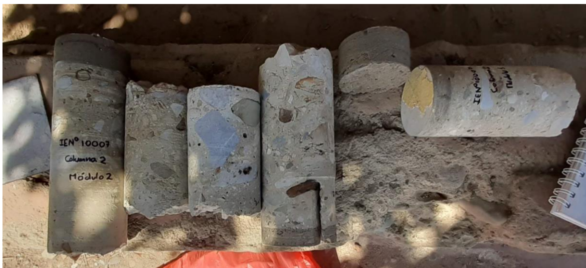
Ilustración 51: Toma de medidas de los corazones diamantinos extraídos
