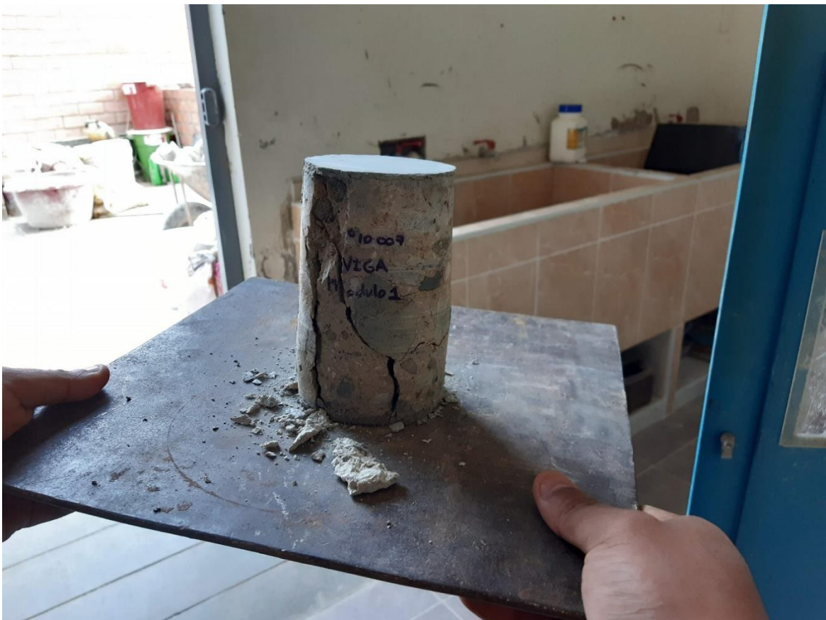
Ilustración 53: Muestra fracturada luego del ensayo
