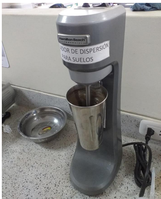
Ilustración 45: Batido de las muestras para el Ensayo granulométrico por sedimentación
