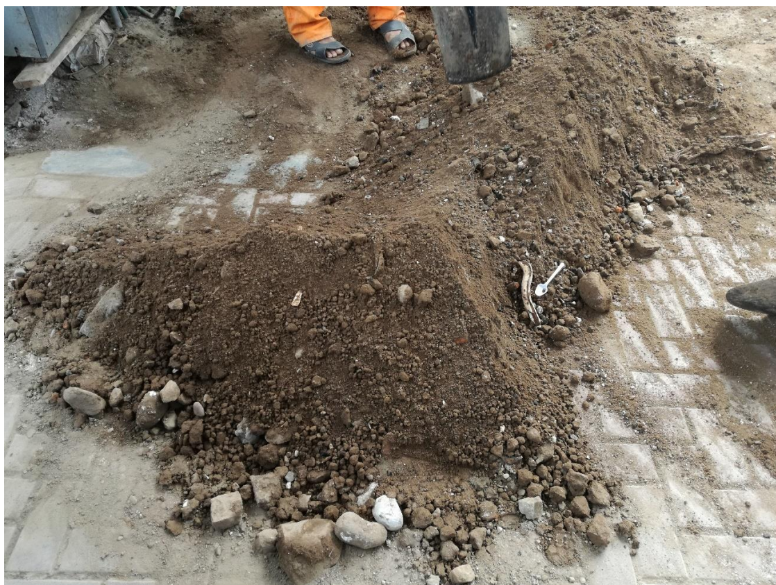
Ilustración 31: Material extraído calicata N°1, relleno no seleccionado
