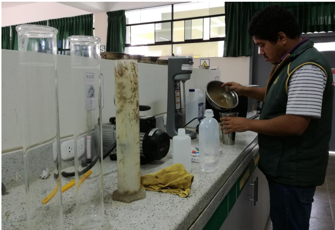
Ilustración 45: Batido de las muestras para el Ensayo granulométrico por sedimentación
