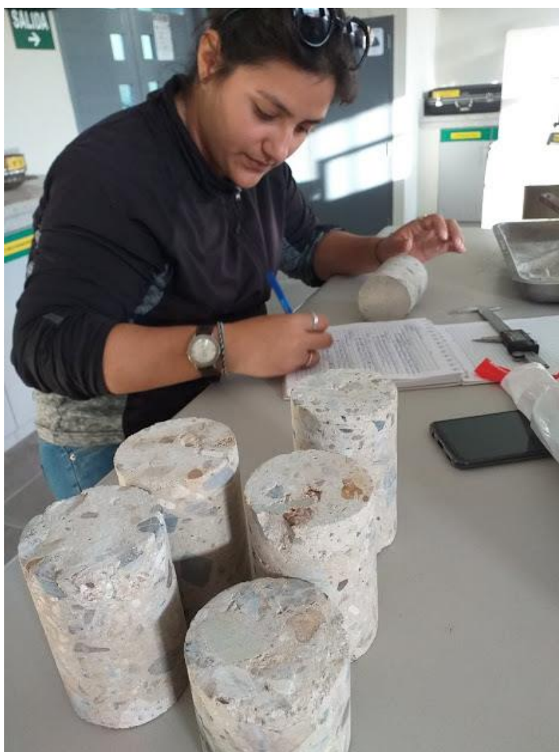
Ilustración 51: Toma de medidas de los corazones diamantinos extraídos
