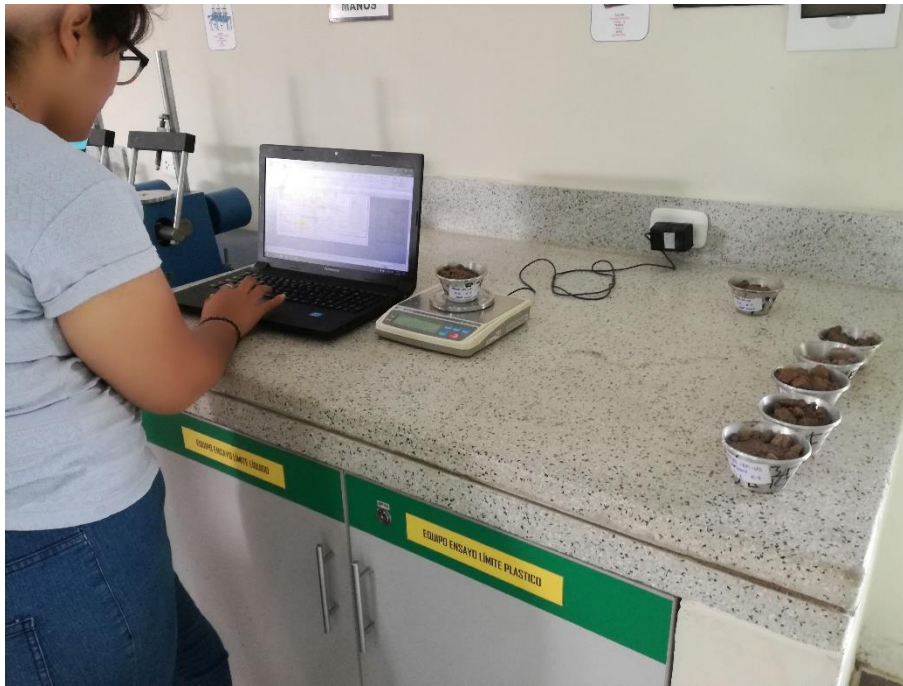
Ilustración 38: Pesado de las muestras del Ensayo de contenido humedad.
