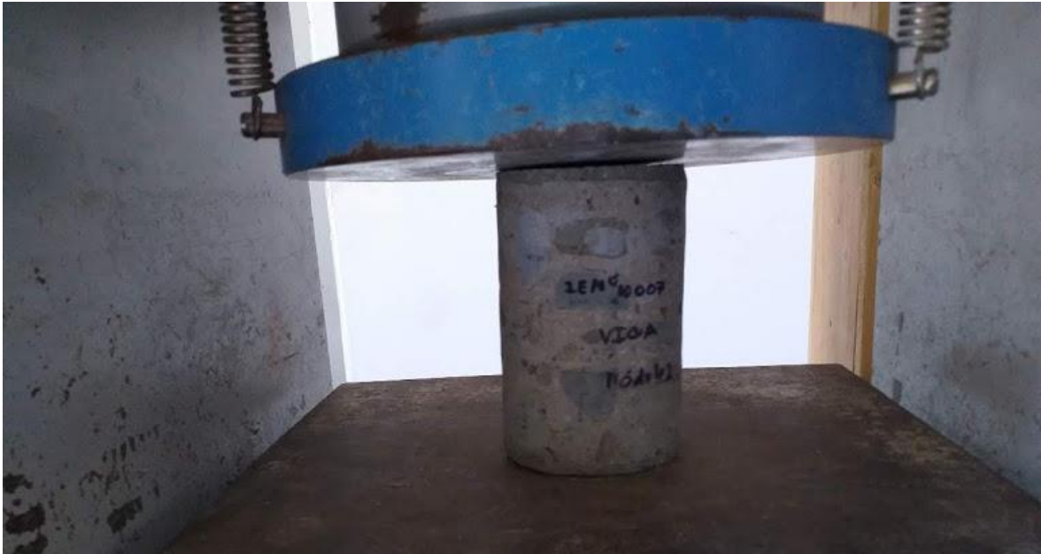
Ilustración 52: Prueba de resistencia a la compresión de los corazones diamantinos
