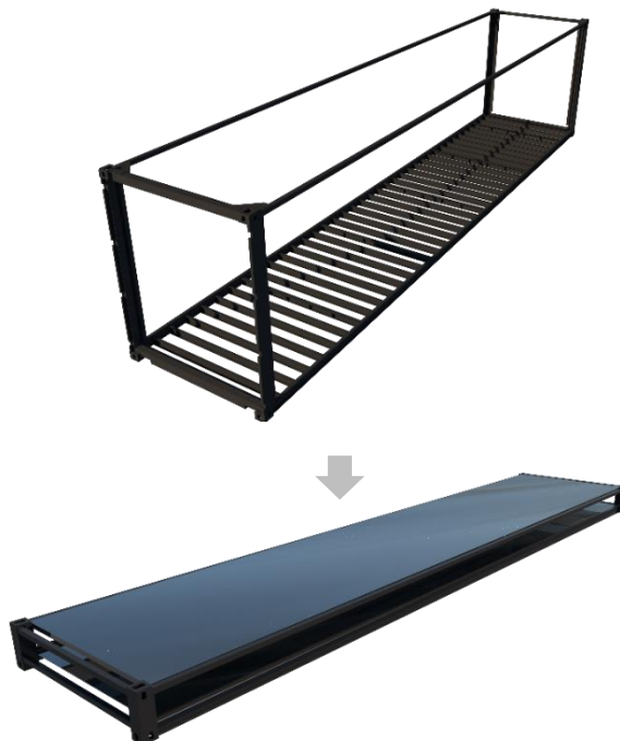
Figura 35. Modo de ensamblaje para su transporte.
