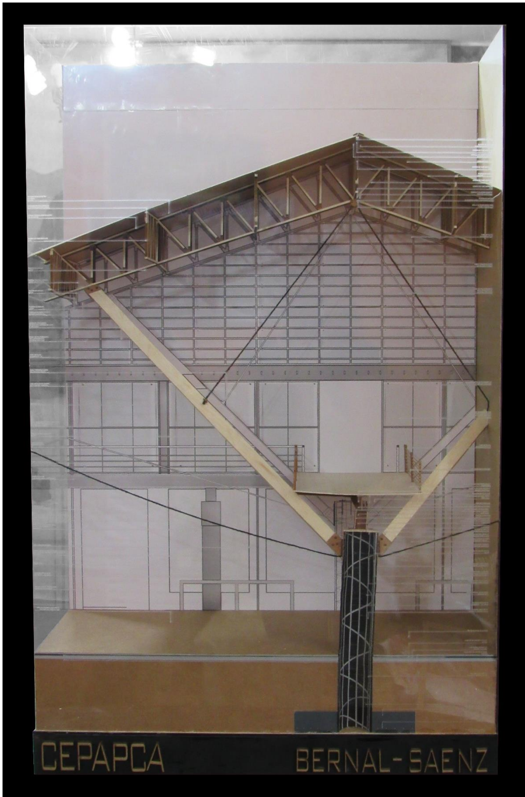
Figura 47: Maqueta del corte constructivo
