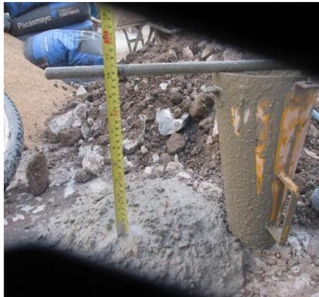
**Figura 58:** Se observa el asentamiento donde se obtuvo de 10 pulgadas.
