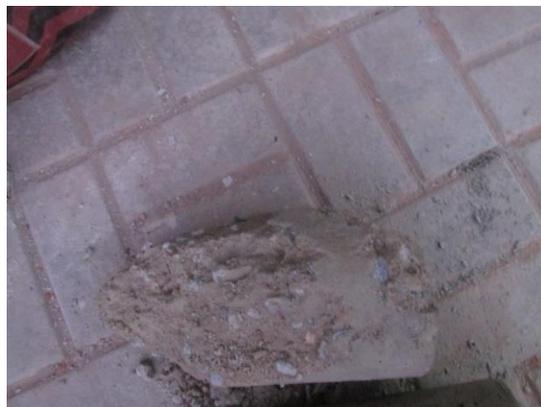
**Figura 121:** Falla de rotura no existe una buena distribución de agregados en le testigo.
