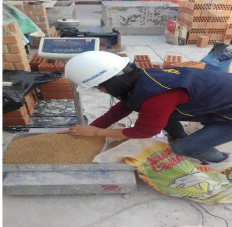
**Figura 102:** Se observa el peso de la arena que se usara para elaboracion de los testigos de concreto en el laboratorio de acuerdo los datos de diseño de mezclas.
