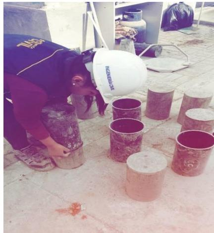
**Figura 111:** Se muestra el desencofrado pasado los 24 horas.
