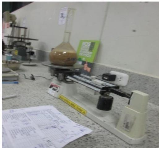
**Figura 36:** Se muestra el peso de la fiola mas la muestra llenado a 500 cm<sup>3</sup> y su peso final.
