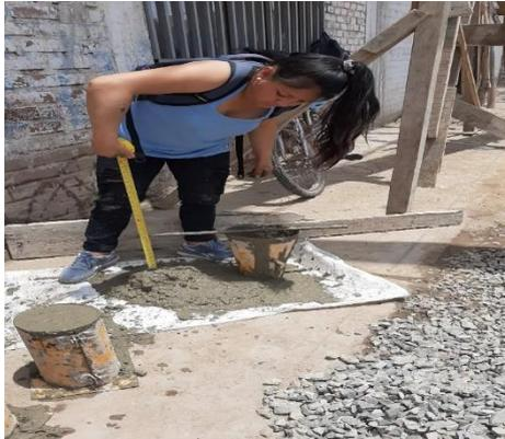
**Figura 91:** Obtención del asentamiento con el cono de Abrams de 8.3 plg.
