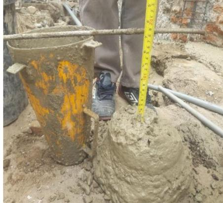
**Figura 55:** Medición del asentamiento con el cono donde se obtuvo 8.7 cm.
