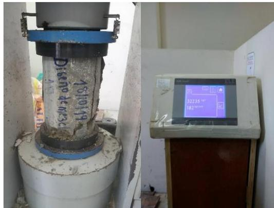
**Figura 116:** Se muestra la resistencia máximo de la ruptura de probetas a los 28 días.
