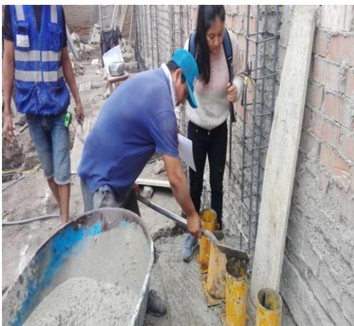
**Figura 46:** Se muestra la obtención de muestras de la estructura de la zapata.
