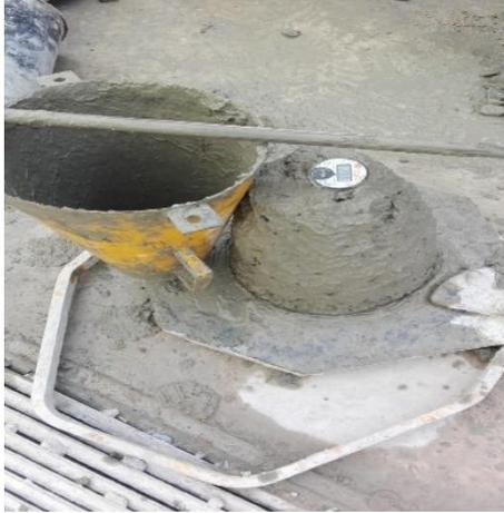
**Figura 108:** Se realizó la temperatura del concreto fresco.
