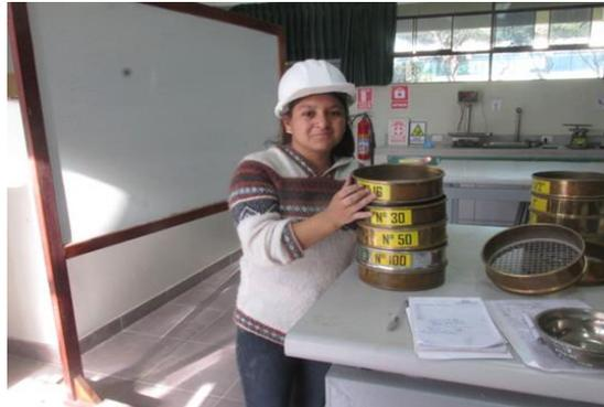
**Figura 35:** Tamizado del agregado fino de acuerdo a la malla normalizada. según
