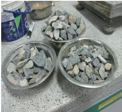
**Figura 42:** Se muestra los diferentes tamaños del agregado grueso para el ensayo de abrasión .
