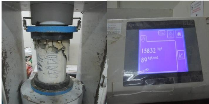
**Figura 120:** Se muestra los resultados máximos de la rotura de las probetas a los 28 días de la vivienda N° 12.
