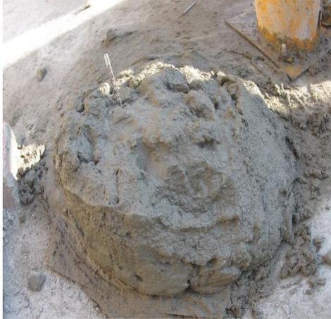
**Figura 61:** Se observa la toma de temperatura de concreto.
