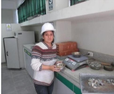
**Figura 39:** Se muestra el peso de la arena para el ensayo contenido de humedad
