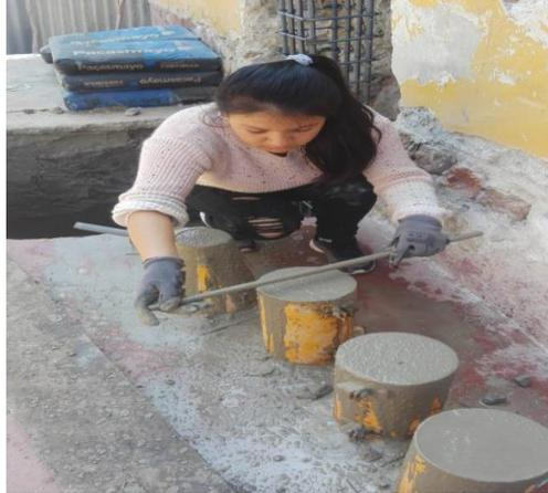
**Figura 49:** Obtención de muestras de la estructura de la zapata para la rotura
