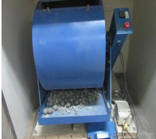
**Figura 43:** Máquina de los angeles para determinar la resistencia a la degradación del agregado grueso.
