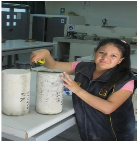
**Figura 113:** Se determina el diámetro de los testigos
