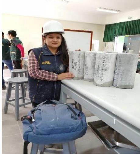
**Figura 114:** Los testigos para la rotura a los 28 días
