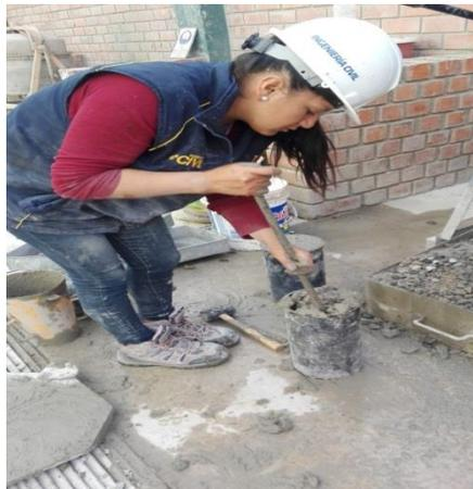
**Figura 109:** Se extraen muestras se realiza en 3 capas cada capa de 25 golpes.
