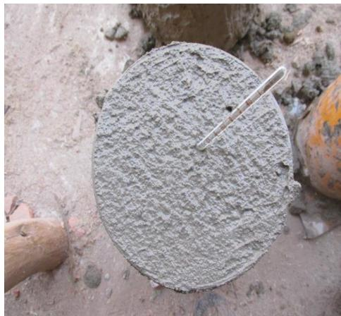
**Figura 96:** Temperatura del concreto fresco a usar.
