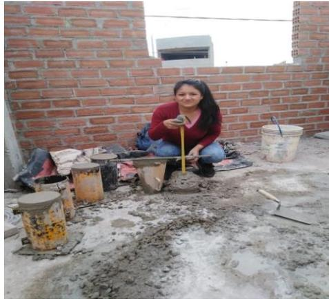
**Figura 65:** Obtención de muestras para la roptura
