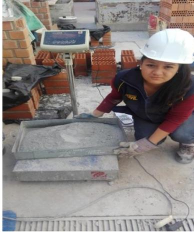
**Figura 100:** Se observa el peso del cemento que se usara para elaboracion de los testigo de concreto en el laboratorio de acuerdo los datos de diseño de mezclas.
