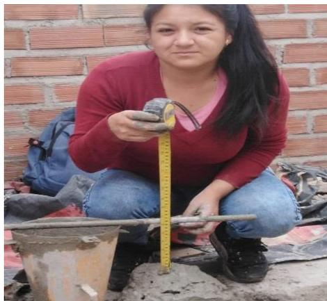
**Figura 64:** Se obtiene el asentamiento con el cono de Abrams Obteniendose de 6.2 pulg.
