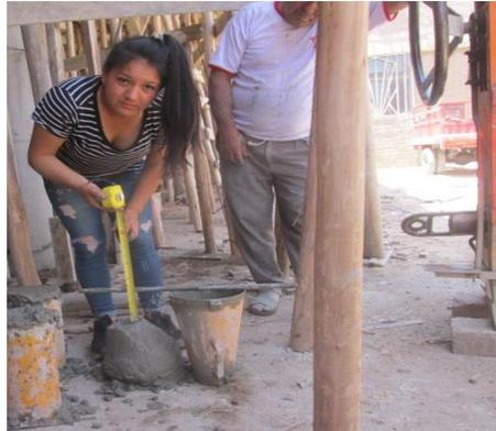
**Figura 95:** Se observa el asentamiento con el cono de Abrams de 4.5 plg.
