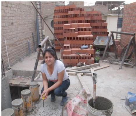
**Figura 86:** Obtención de muestras para la rotura.
