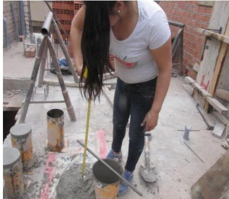
**Figura 87:** Se realiza el asentamiento con el cono de abrams de 8.8 plg.
