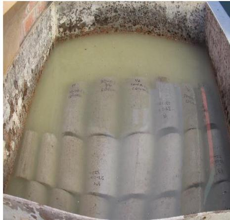
**Figura 112:** Después del desencofrado se procede al curado.
