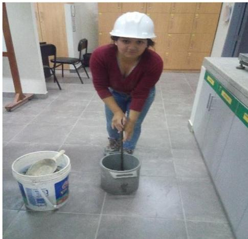
**Figura 40:** Se muestra el ensayo de peso volumétrico compactado del agregado grueso se realiza en 3 capas.
