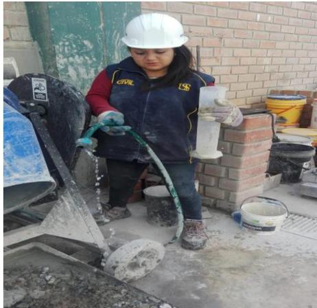
**Figura 103:** Se observa el agua de la arena que se usara para elaboracion de los testigos de concreto en el laboratorio de acuerdo los datos de diseño de mezclas.
