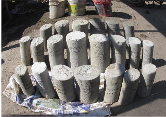
**Figura 118:** Se muestra la recolección de los testigos de las viviendas del distrito de Pomalca.
