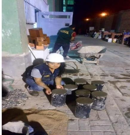
**Figura 110:** Se muestra los moldes llenos de muestra se deja enfriar 24 horas.
