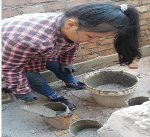
**Figura 51:** Obtención de muestras para la rotura.
