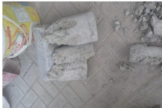
**Figura 117:** Se muestra la distribucion de los agregados es uniforme del agregado grueso es de buena calidad.
