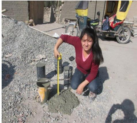
**Figura 71:** Obtención del asentamiento de la muestra que se utilizara.
