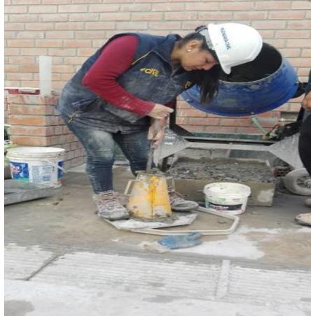
**Figura 106:** Se muestra el ensayo para medir el cono de abrams en la cual se compacta en tres capas con 25 golpes .
