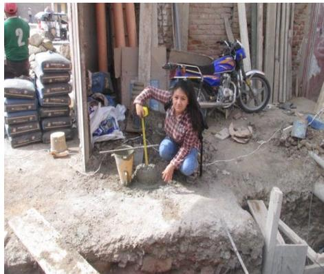
**Figura 80:** Se realiza el asentamiento con el cono de Abrams donde se obtuvo de 6.3 plg.
