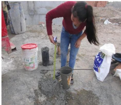
**Figura 76:** Asentamiento con el cono de Abrams donde se observa 6.5 pulg.
