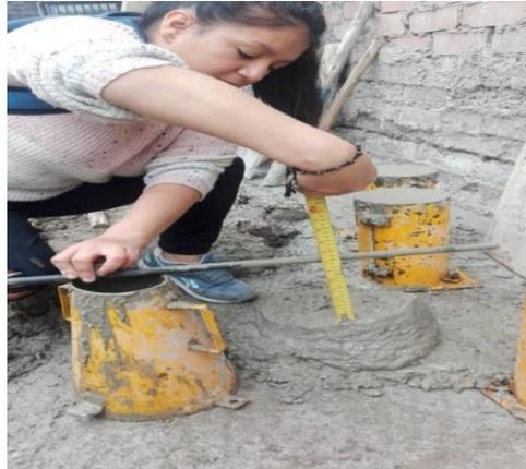
**Figura 47:** Se realiza el asentamiento con el cono de abrams.
