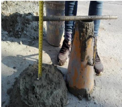
**Figura 52:** Medición del asentamiento con el cono donde se obtuvo 9 cm.
