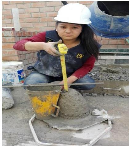
**Figura 107:** Se determina el asentamiento de 3 a 4 plg.
