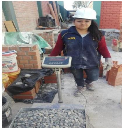
**Figura 101:** : Se observa el peso del agregado greso que se usara para elaboracion de los testigos de concreto en el laboratorio de acuerdo los datos de diseño de mezclas.
