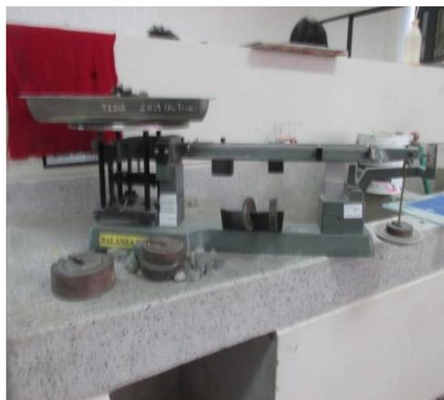
**Figura 38:** Peso del agregado grueso una vez secado con la franela para el ensayo del peso específico.
