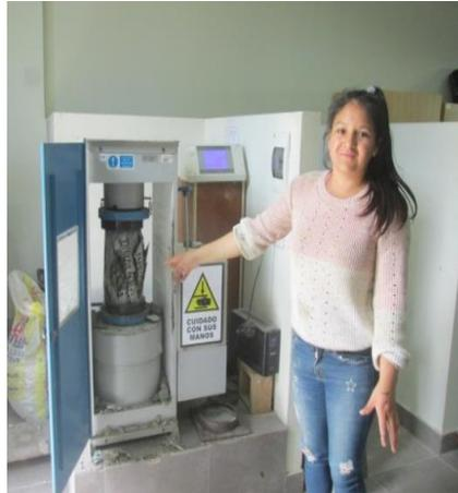
**Figura 115:** Se muestra la rotura de las probetas de hormigon.
