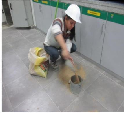
**Figura 13** : Se observa la muestra del agregado fino para el ensayo del peso unitario.
