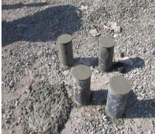
**Figura 73:** Se obtiene la obtención de muestras para la rotura.
