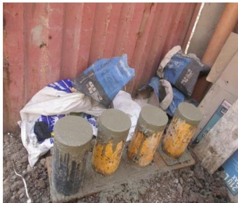
**Figura 78:** Se obtiene la obtención de muestras de concreto para la rotura.
