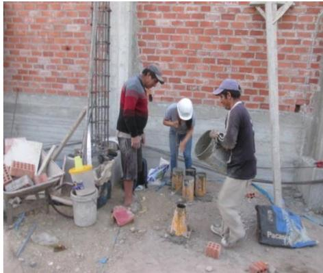
**Figura 83:** Se obtienen la obtención de las muestras para la roptura.
