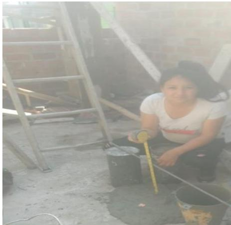
**Figura 98:** Se observa el asentamiento con el cono de Abrams
