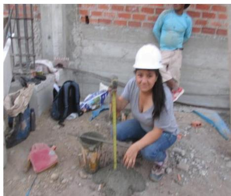
**Figura 84:** Obtención del asentamiento con el cono de Abrams de 8.3 plg.
