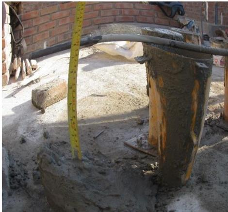
**Figura 62:** Se obtiene el asentamiento del concreto con el cono de abrams.
