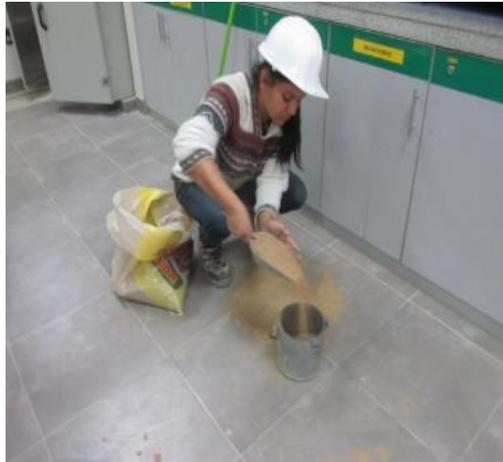
**Figura 41:** Se muestra el ensayo de peso volumétrico suelto del agregado fino.
