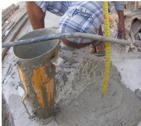
**Figura 70:** Se obtiene el asentamiento donde es 8.5 pulgadas.
