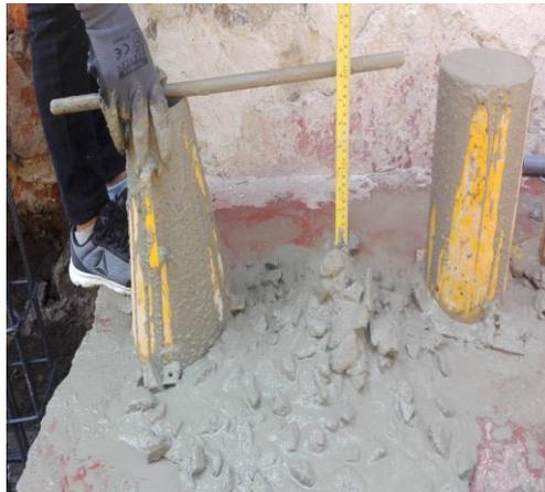
**Figura 50:** Medición del asentamiento con el cono donde se obtuvo 8.5 cm.
