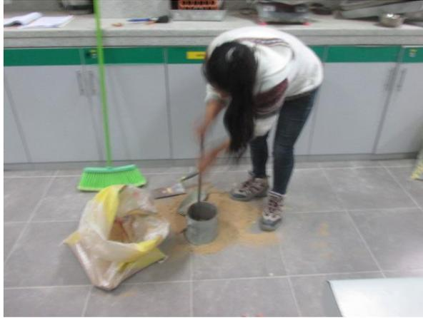
**Figura 14:** Se observa la muestra del agregado fino para el ensayo del peso
