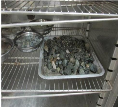
**Figura 45:** Una vez lavado el material se seca al horno a una temperatura de 105°C
