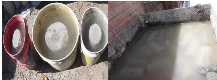
**Figura 119:** Se muestra la recolección de los testigos de las viviendas en condición de autoconstrucción Pomalca- curado.
