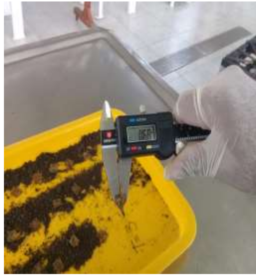
Anexo 5.D. medición de espesor.
