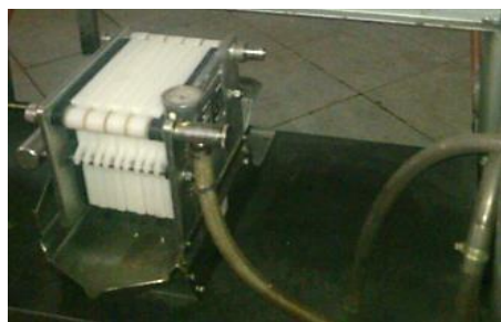
Figura 6: Filtro de 5 placas
