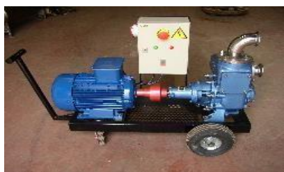
Figura 8: Bomba de trasiego
