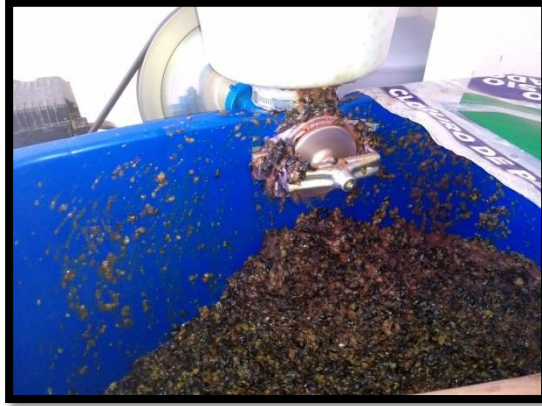
Figura 27: Maquina molino - Proceso de estrujado
