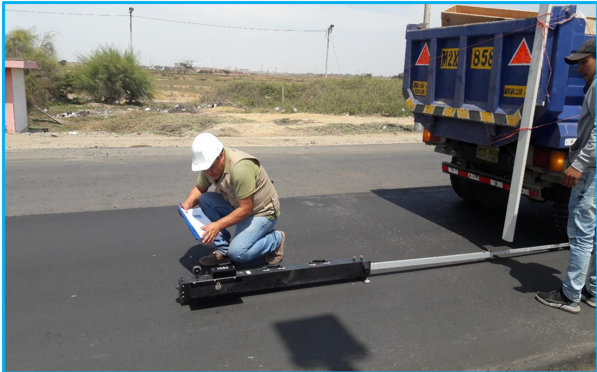
Fotografía 03: El camión cargado se desplaza lentamente hacia delante y se realizan las lecturas de los diales.
