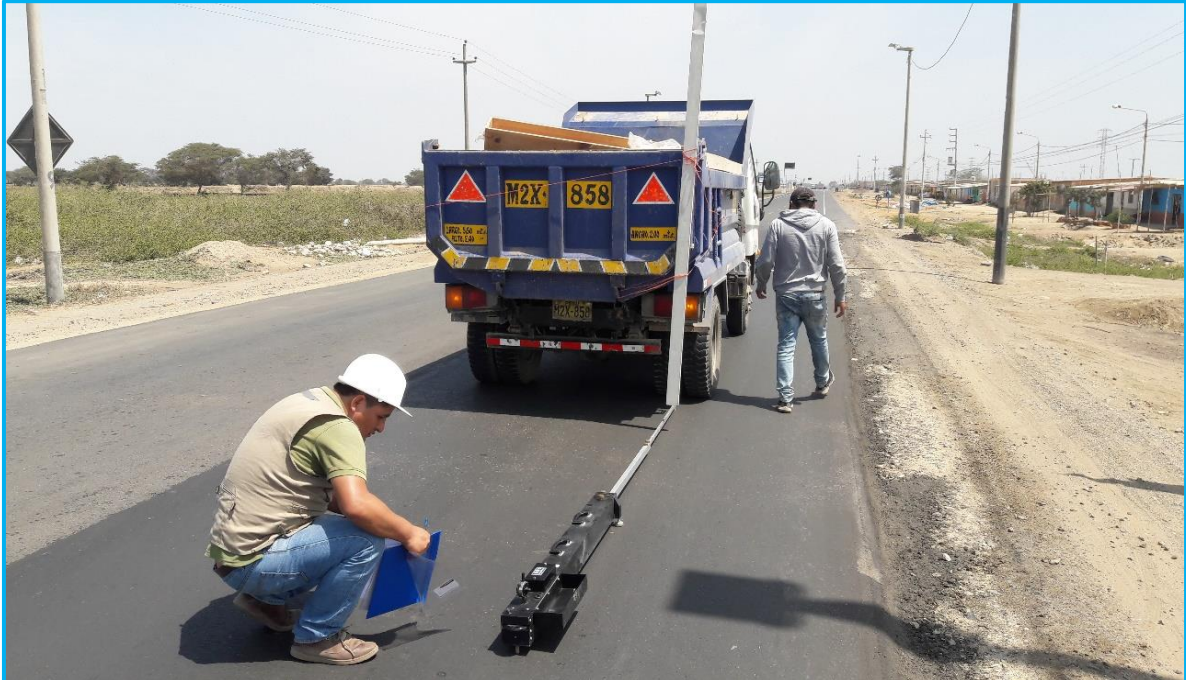
Fotografía 02: Retroceso lento del camión observando el dial del primer brazo del instrumento.
