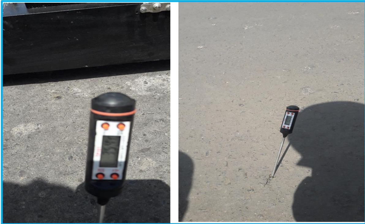
Fotografía 01: Realización del Orificio para la medición de la temperatura antes de realizar el ensayo.
